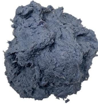
Fig. 43. Collante Menigel T70 miscelato con acqua
