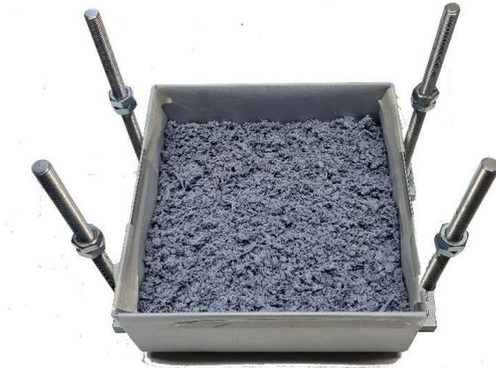
Fig. 30. Riempimento stampo con scarti e collanti prima della pressatura
