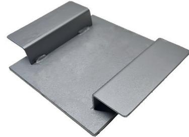
Fig. 24. Apposito coperchio per il provino  $\beta$  per essere utilizzato con la pressa.
