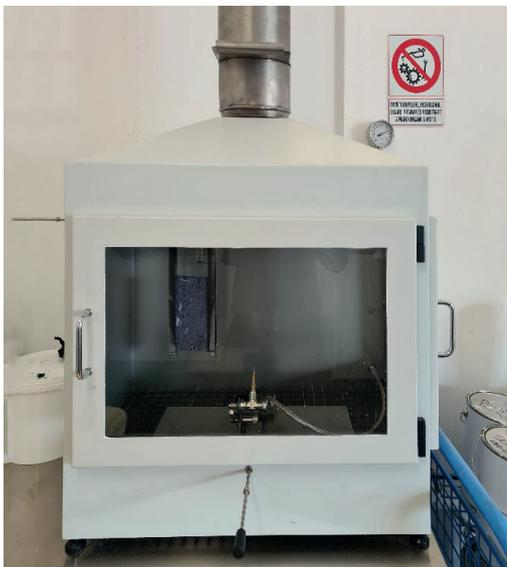
Fig. 6. Ambiente di misura per prova di reazione alla fiamma, azienda ELACHEM
