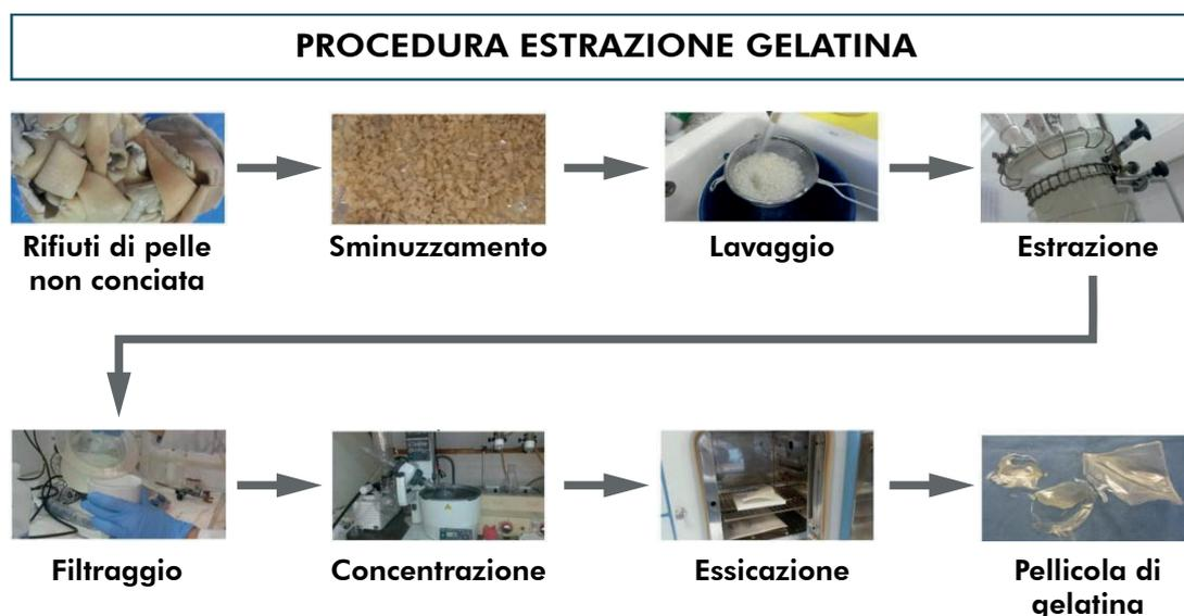
Fig. 10. Schema della procedura proposta, in scala di laboratorio, per il pre-trattamento di sottoprodotti non conciati e l'estrazione di gelatina<sup>34</sup>.
