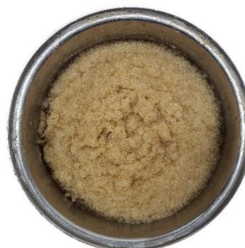
Fig. 45. Collante Menigel T80 miscelato con acqua
