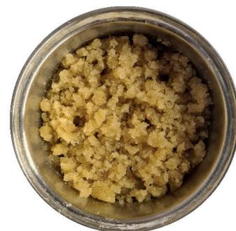
Fig. 41. Collante Menigel T70 miscelato con acqua
