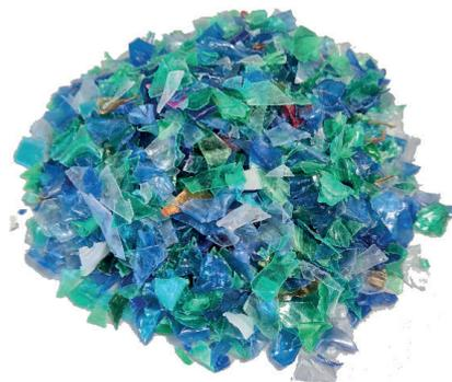
Fig. 18. PET triturato per la realizzazione della resina
