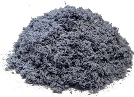
Fig. 26. Scarti conciari della lavorazione di rasatura
