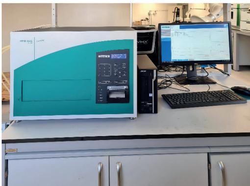
Fig. 2. Misuratore NETZSH modello HFM 446 dell'azienda ELACHEM
