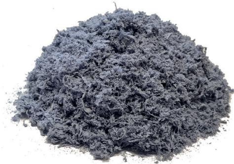
Fig. 31. Scarti conciari della lavorazione di rasatura
