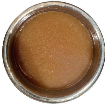
Fig. 46. Collante Menigel T80 riscaldato a bagnomaria
