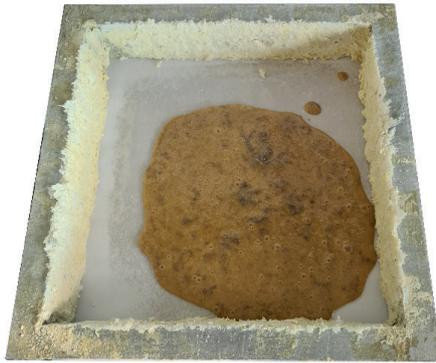
Fig. 56. Inserimento della miscela liquida nello stampo
