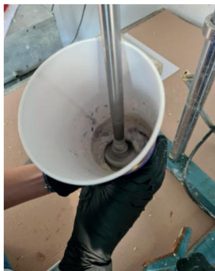
Fig. 55. Impasto dei vari componenti tramite miscelatore
