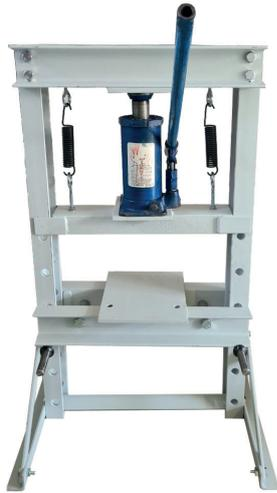
Fig. 23. Pressa manuale utilizzata per applicare la pressione sui provini
