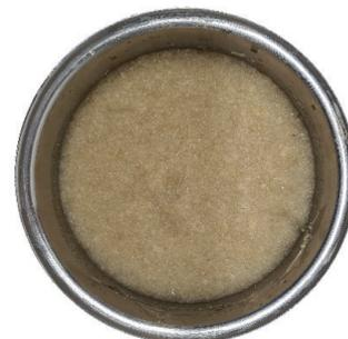
Fig. 49. Collante Menigel T100 miscelato con acqua
