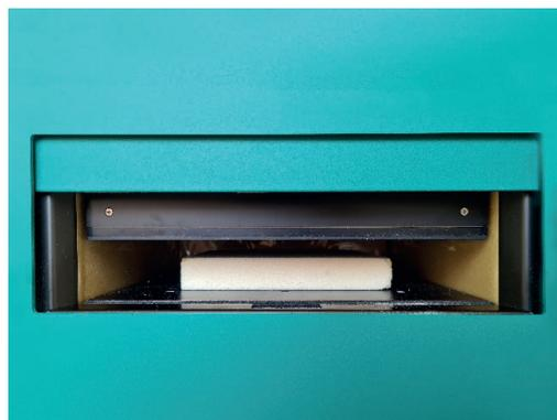
Fig. 3. Inserimento del provino all'interno del misuratore
