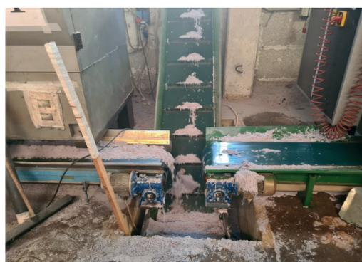
Fig. 6. Raccolta scarti con nastro trasportatore, azienda BpBenetti
