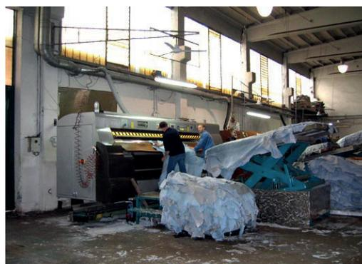
Fig. 4. Fase di rasatura, <http://www.bpbenetti.com/>
