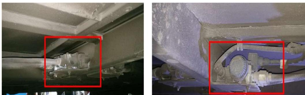
*Figura 38. Elettrovalvole del circuito ECAS presente sul veicolo 33E. (Trancuccio, 2018)*
