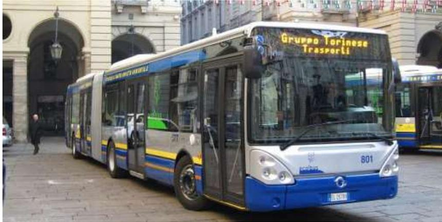
*Figura 22. Irisbus Citelis da 18 metri a 4 porte*
