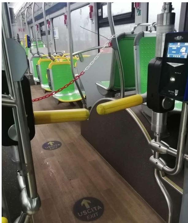
*Figura 5. Tornelli posti per una sperimentazione sull'autobus utilizzato nello studio svolto*
