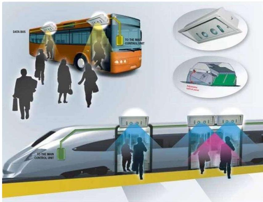
Figura 13. Telecamere poste all'ingresso del T1 Tramway delle Tranvie Elettriche Bergamasche ([www.eurotech.com](http://www.eurotech.com))
