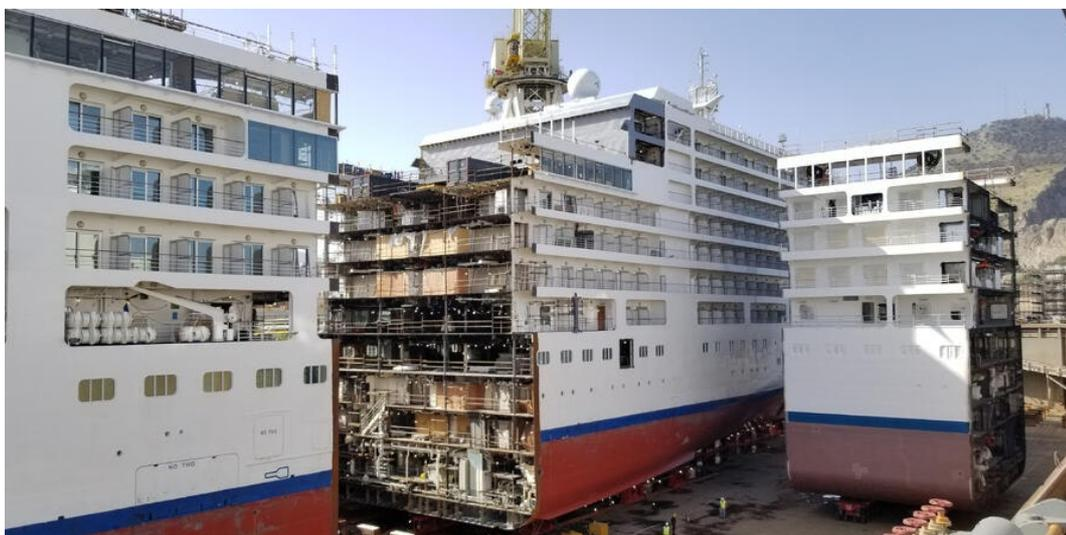
Figura 2.6 - Ship stretching della nave Silver Spirit. Fonte (www.cruisecritic.com)
