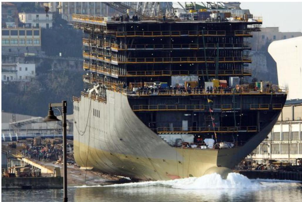
*Figura 2.10 - Varo del troncone prodiero della Costa "Riviera". Fonte (LaPresse)*
