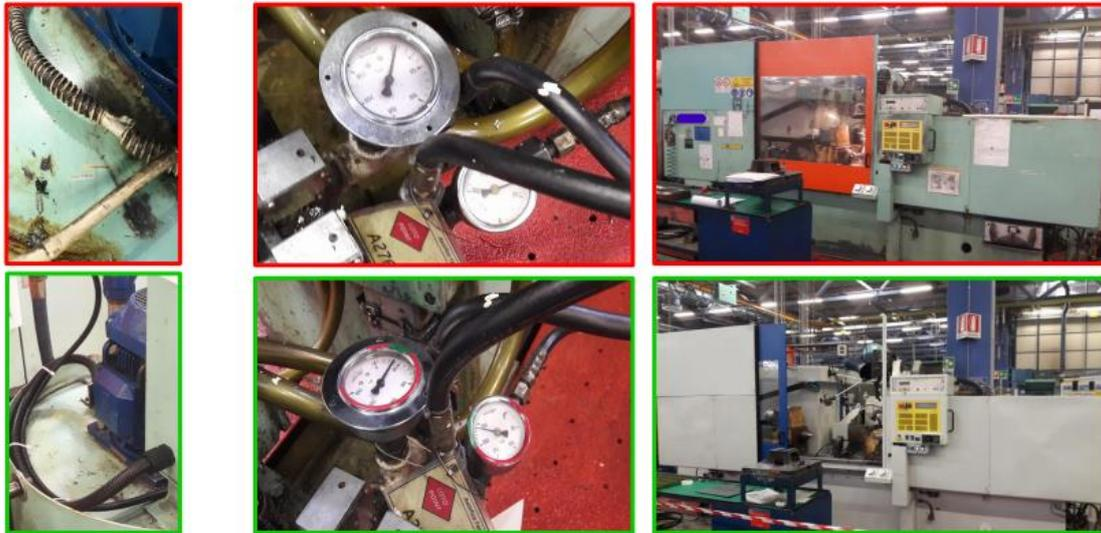
Figura 27- Ripristino degrado Accelerato
