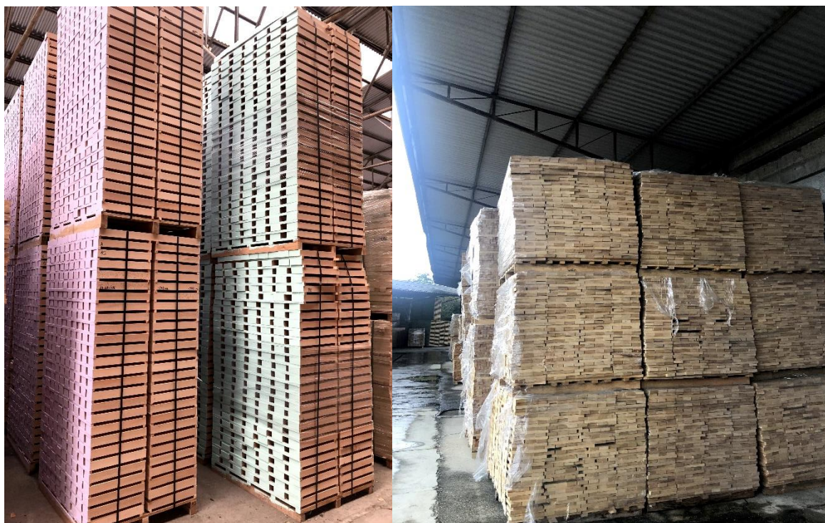
Figura 2.7 – Listellati a sinistra con udc dalle grandi altezze e coppafissa a destra con udc più basse e compatte
