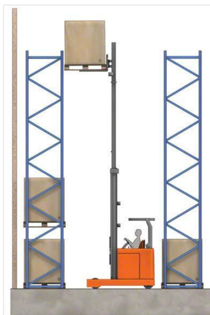
Figura 3.21 – Confronto operativo tra il carrello con montante retrattile e il carrello a forche frontali.
