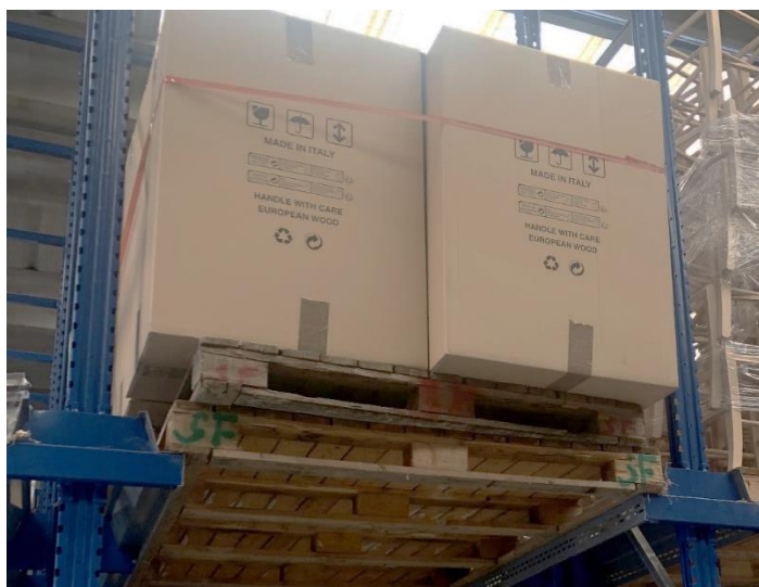
Figura 3.2 – Esempio di un pallet di sostegno ad un imballo che già prevede un pallet costruito ad hoc per la quantità di semilavorati spediti (Fonte: magazzino uguale ed adiacente al magazzino E).
