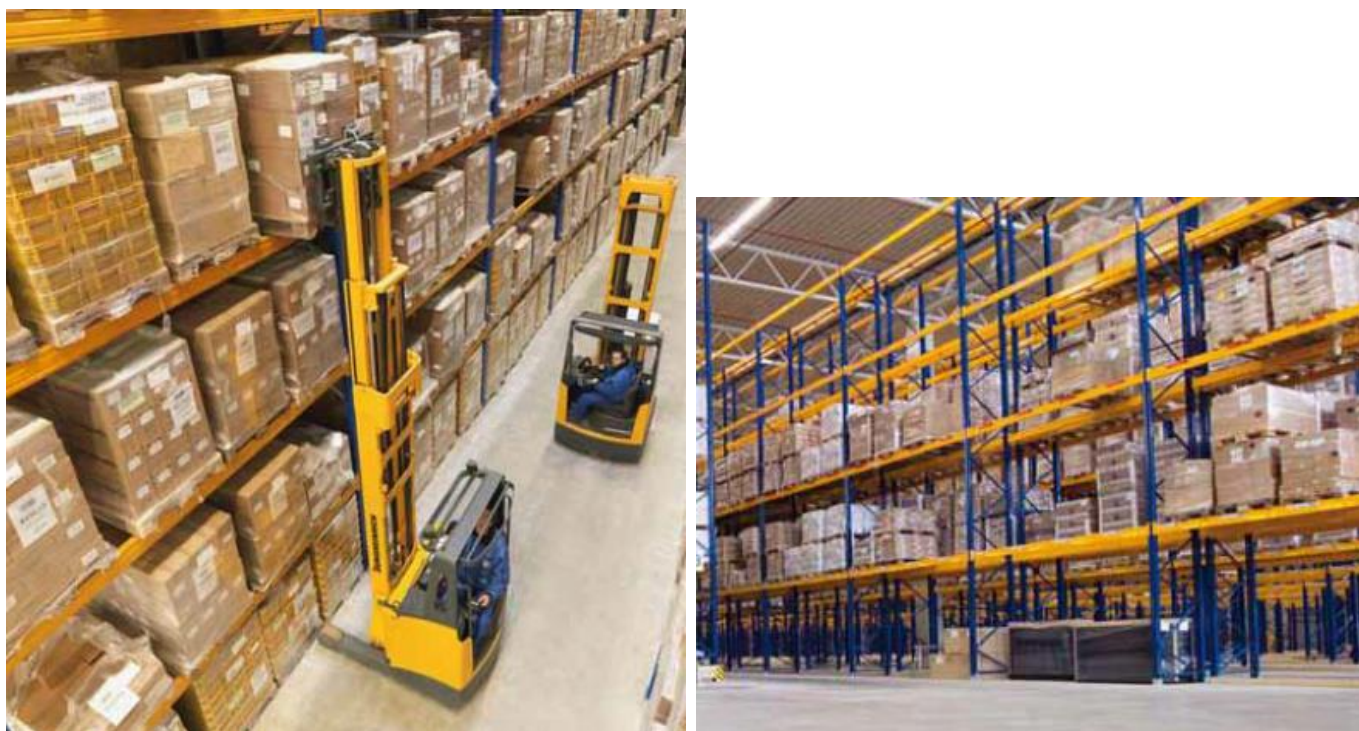
Figura 3.22 – Esempio di scaffalatura tradizionale con 4 locazioni per ogni vano disponibile.
