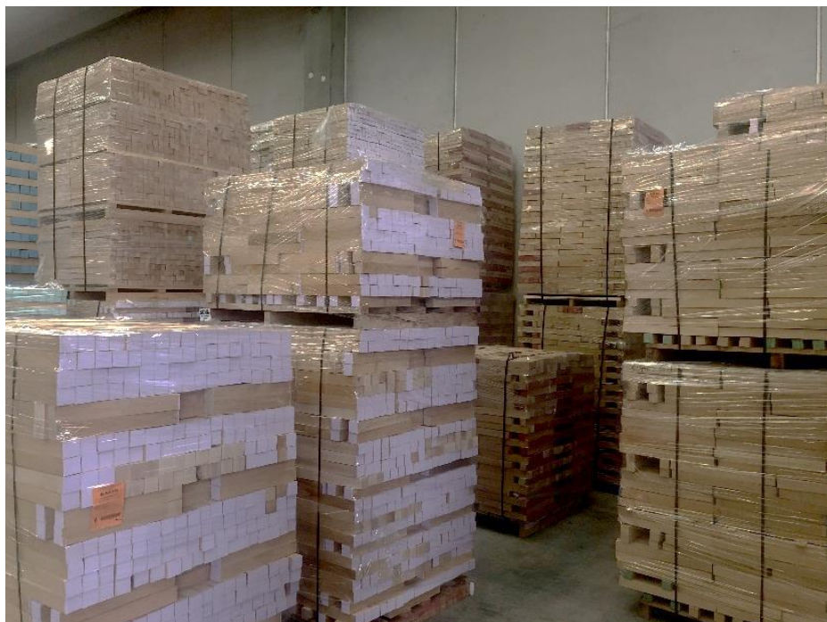
Figura 3.19 – Spazi liberi che si formano con l'immagazzinamento a catasta di imballi legnosi.
