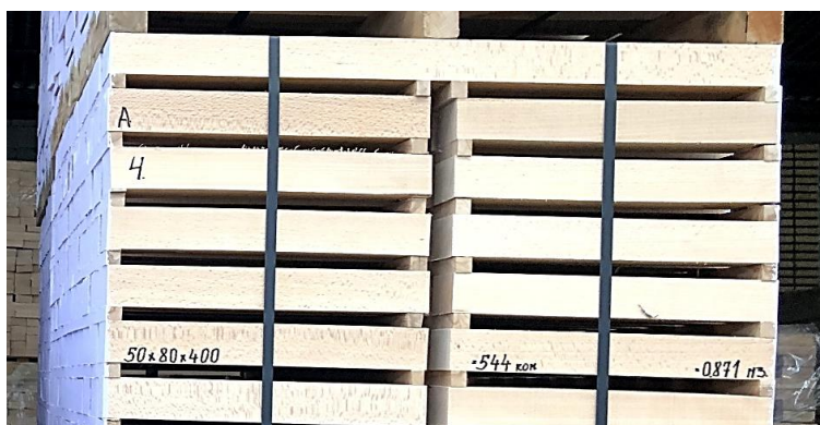
Figura 2.8 – Esempio di caratteristiche riportate sull'unità di carico stessa
