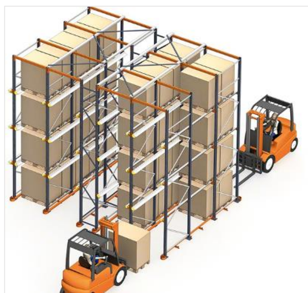
Figura 3.4 – Scaffalatura Drive-Through con accessibilità da entrambi i lati della scaffalatura.
