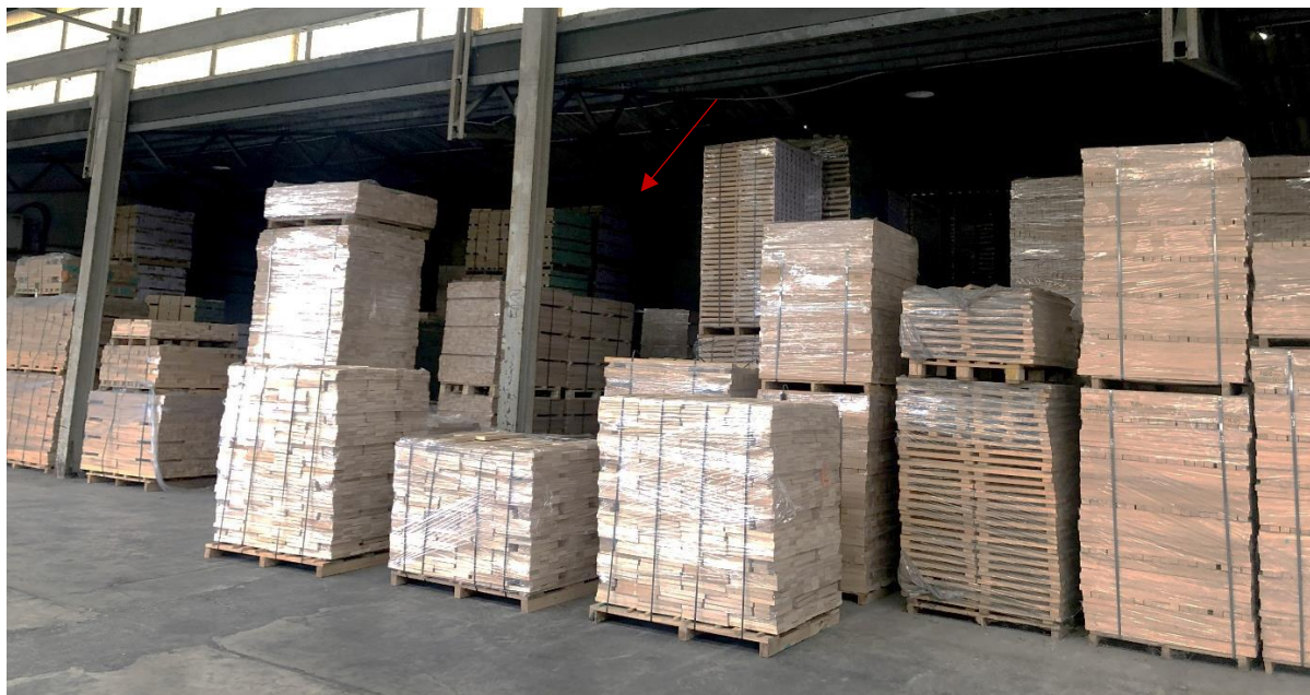
Figura 2.9 – Esempio di profondità nel magazzino A che rende complicato il prelievo di una udc
