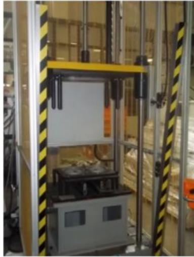
Figura 17: esempio di una pressa di piantaggio verticale usata nel processo di assemblaggio
