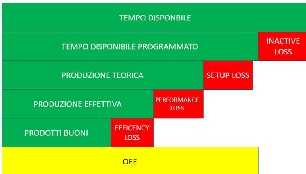
Figura 19: la figura rappresenta lo schema di calcolo dell'indicatore OEE
