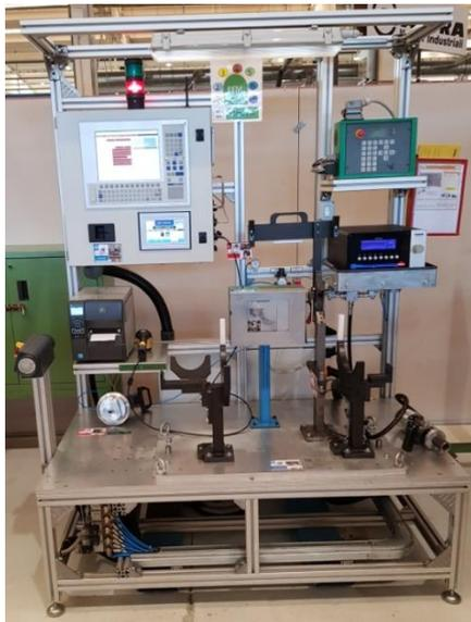
Figura 18: nell'immagine è rappresentata un esempio di macchina utilizzata per il test della tenuta
