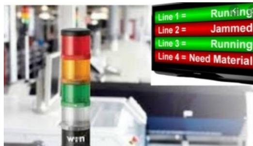
Figura 38: esempio di utilizzo del sistema ANDON
