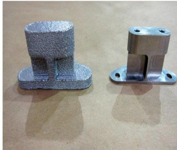
*Figura 21: Staffa guida d'onda per la missione Juno [95]*
