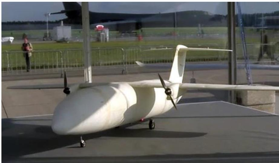
*Fig. 17. "Thor". First 3D printed mini airplane*
