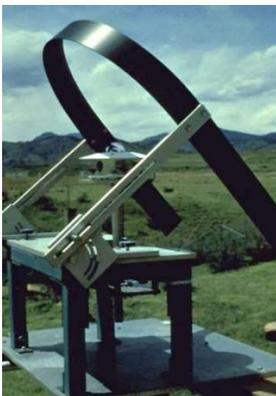
Figura 2.8 Solarimetro con anello ombreggiante [4]
