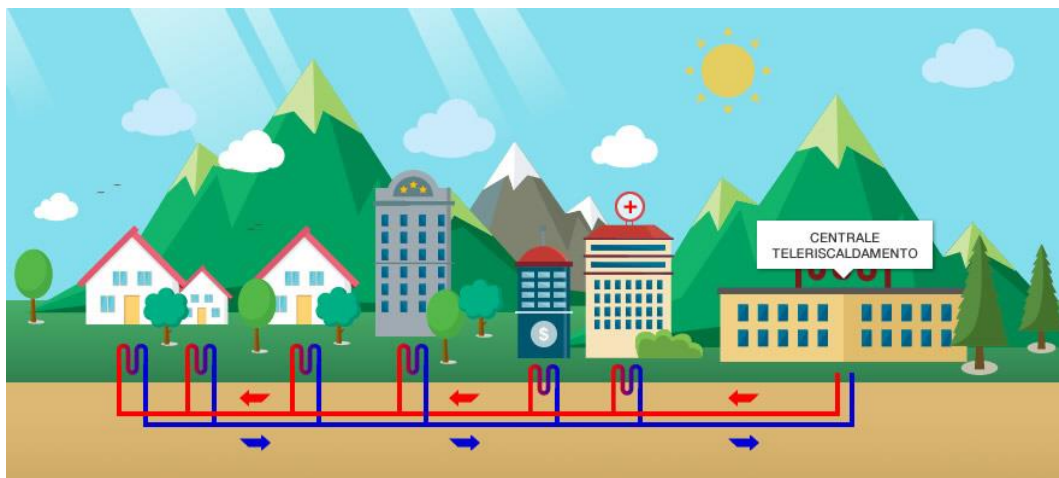
Figura 7 – Schema di massima rete di teleriscaldamento generica [5]
