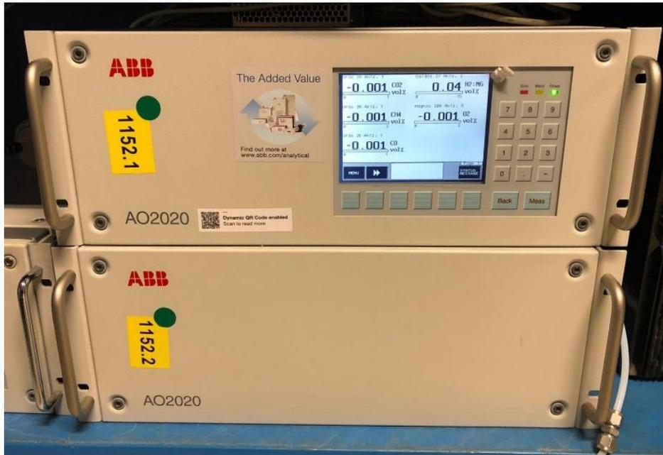
**Figura 2.13:** Analizzatore NDIR ABB
