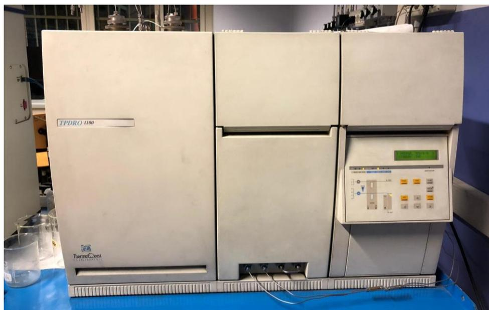
**Figura 2.6:** Analizzatore TPD/R/O 1100 (Catalytic Surface Analyzer) della ditta TermoQuest
