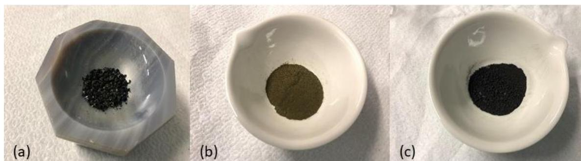
**Figura 2.3:** (a) campione essiccato in stufa a 70°C @ 8h, (b) campione essiccato e tritato al mortaio, (c) campione calcinato a 650°C @ 4h
