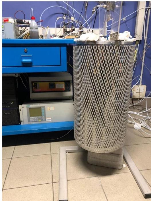
**Figura 2.11:** Forno dotato di scambiatore di calore a struttura cilindrica per effettuare il test catalitico
