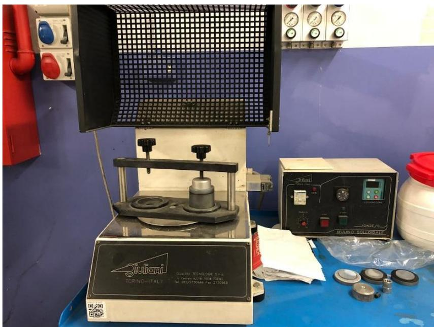
**Figura 2.12:** Mulino colloidale (ball milling) per creare il contatto stretto (tight contact) tra le fasi.
