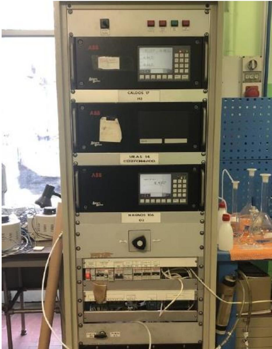
**Figura 2.5.** Analizzatore di gas in continuo utilizzato in laboratorio per i test catalitici.
