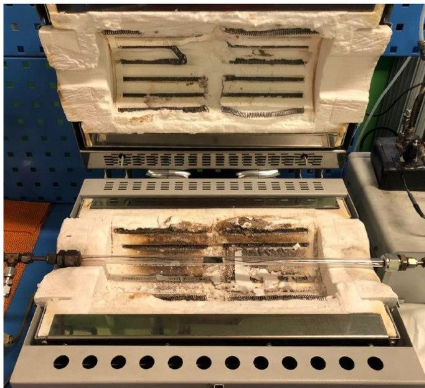
**Figura 2.2.** Reattore tubolare in vetro di laboratorio ( $d=10\text{mm}$ ), sistema catalitico e fornace elettrica.
