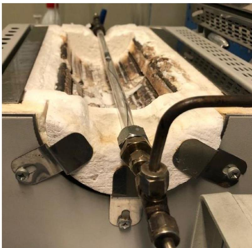
**Figura 2.3.** Termocoppia di tipo K (*chromel-alumel*): ingresso del flusso di gas al reattore.
