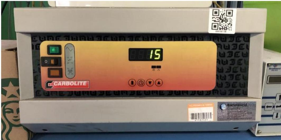
**Figura 2.4.** Controllore di temperatura con logica del tipo PID regolabile manualmente.
