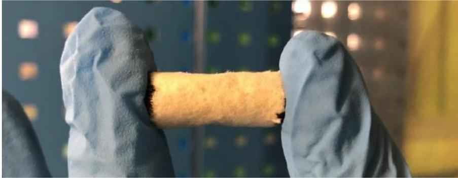
**Figura 2.4.** Catalizzatore strutturato ricoperto da vermiculite pronto per essere posto all'interno del reattore.
