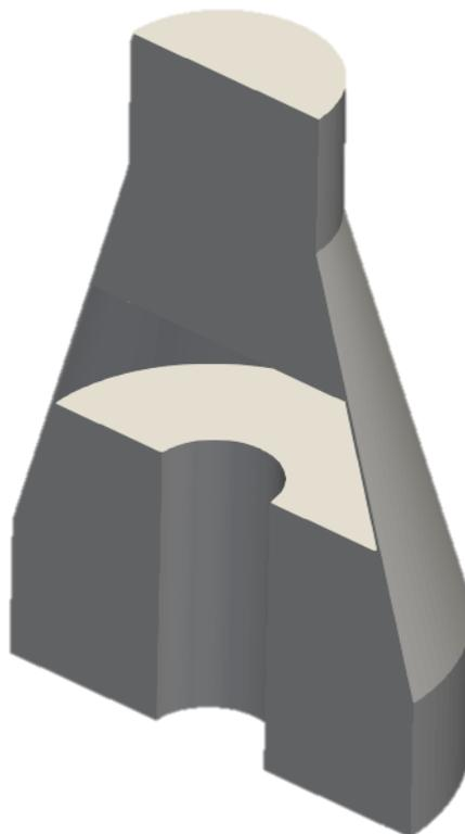
Figura 4-7 Geometria in tre dimensioni del cone mill mixer; indicati come blocchi di colore grigio le zone di fluido del dominio computazionale.
