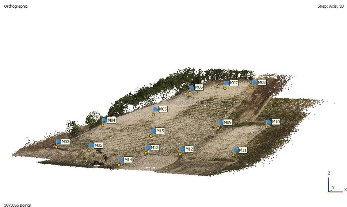
Figura 3.2 - Nuvola di punti sparsa. In figura sono evidenziate le posizioni dei marker.
