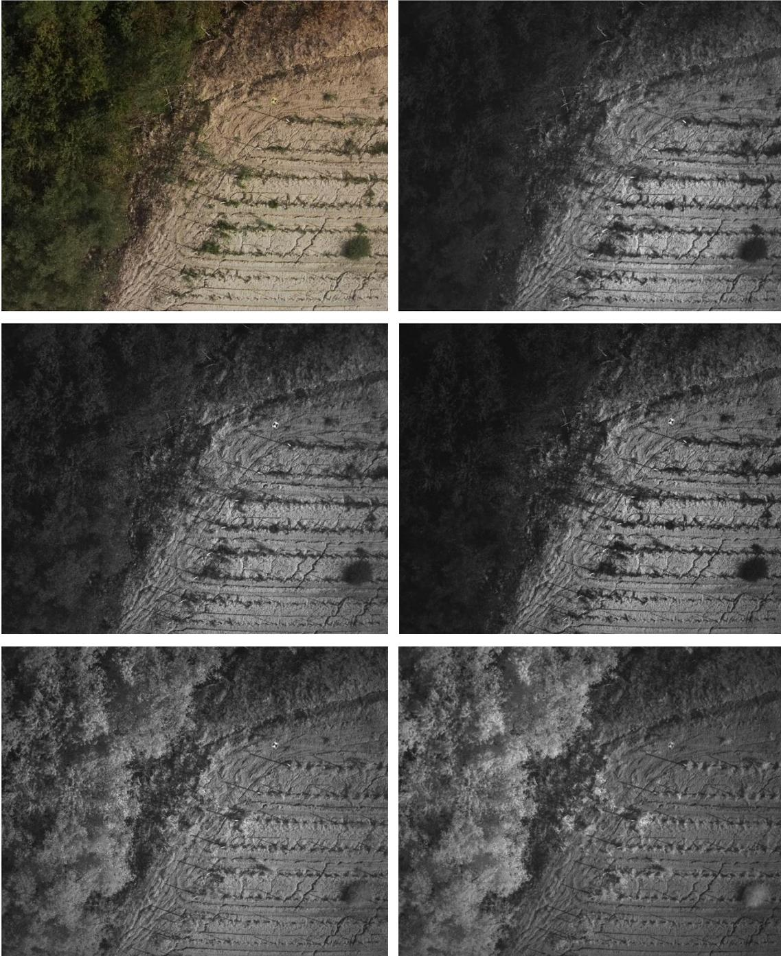
Figura 2.5 – Confronto tra le diverse immagini ottenute dal *Phantom 4 multispectral* per l'angolo nord-ovest del vigneto. In ordine: RGB, Blu, Verde, Rosso, *Red-Edge*, NIR.
