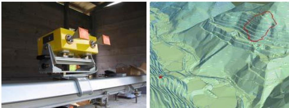
Figura 270-Monitoraggio in superficie con GBInSAR
