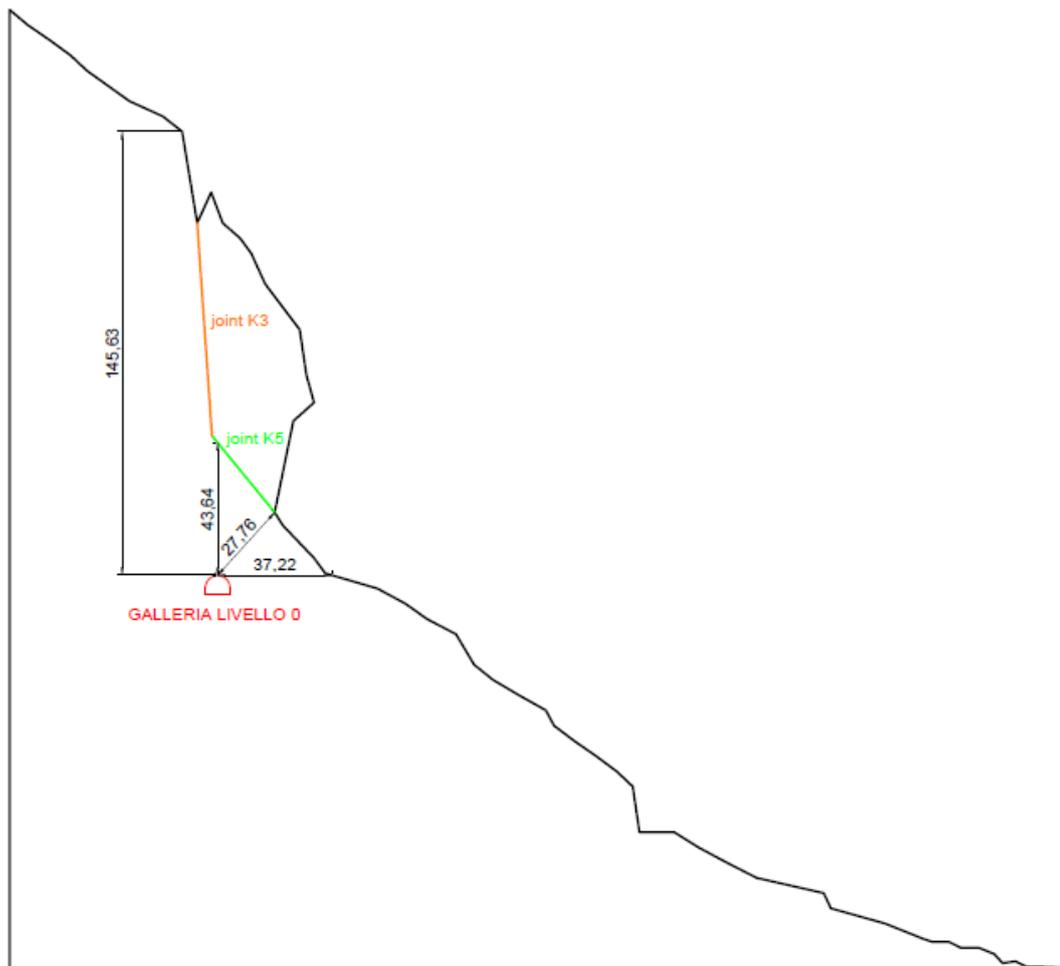
Figura 46-Rappresentazione della sezione di riferimento con all'interno la galleria tramite il software AutoCad
