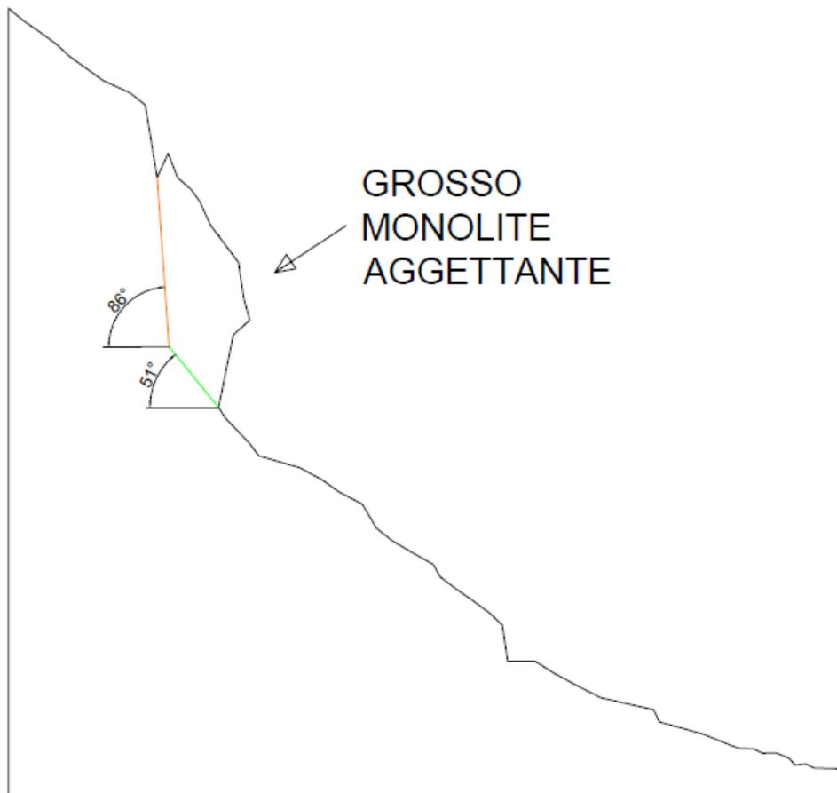
Figura 42-Modello geometrico 2D del versante riprodotto con il software AutoCad
