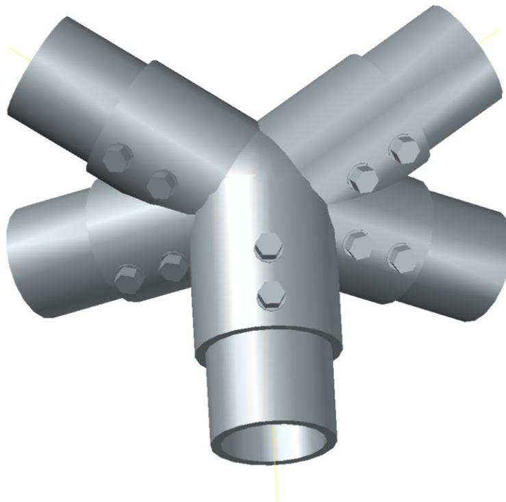
*Fig. 6.8 - Elaborazione CAD di un nodo tipo della struttura, dovuta all'aggregazione dell'endecaedro bisimmetrico, nella soluzione di giunzione con bullonatura*
