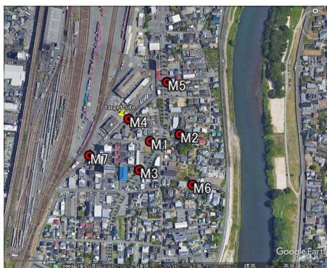
**Figura 5.7** Disposizione dei sensori dell'array KUM-M, dimensione media dei doppi triangoli (122, 243 m) (da Google Earth)
