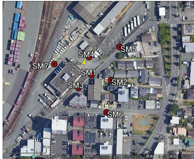
**Figura 5.8** *Disposizione dei sensori dell'array KUM-SM, dimensione media dei doppi triangoli (39, 78 m) (da Google Earth)*
