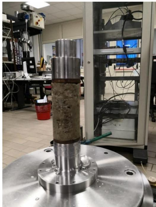
FIGURA 2.3: POSIZIONAMENTO DEL CAMPIONE DI ENVIE-LA GRENGIA SULLA BASE DELL'APPARECCHIATURA, POLITECNICO DI TORINO
