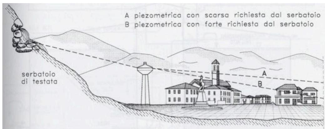
Figura 6.1 – Andamento piezometrica per serbatoio di testata
