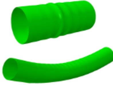
Figura 2.9: Instabilità a mo' di shell-bulking
