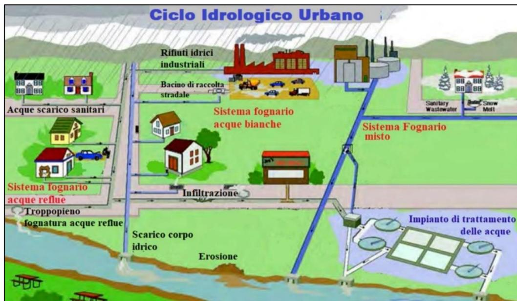
Figura 31: Elementi costituenti una rete di drenaggio urbana mista o separata (EPA SWMM, 2015).
