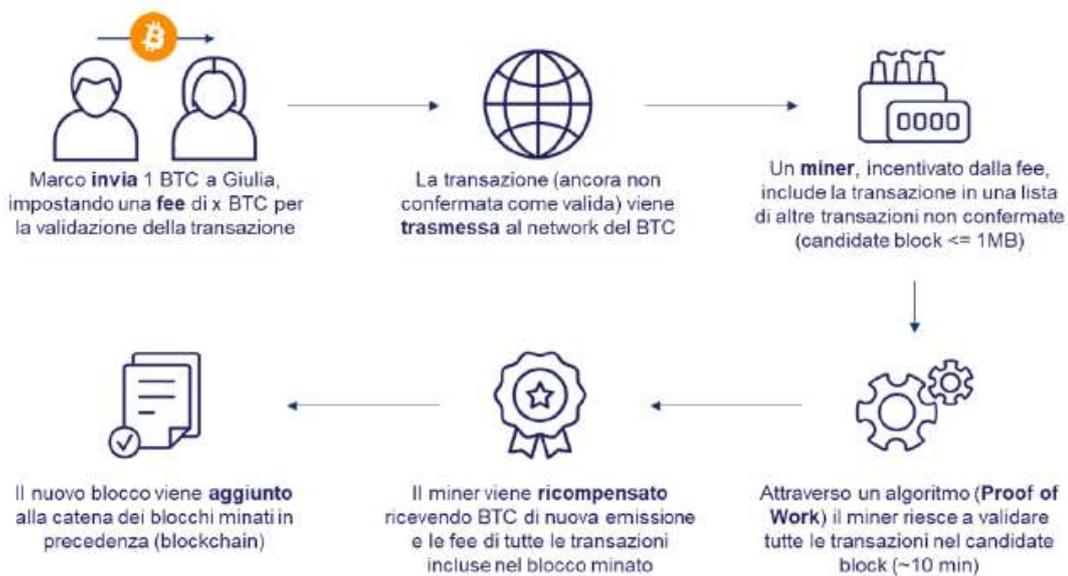
Figura 1.13 Processo di validazione di una transazione ([www.focusmgmt.it](http://www.focusmgmt.it)) [38]
