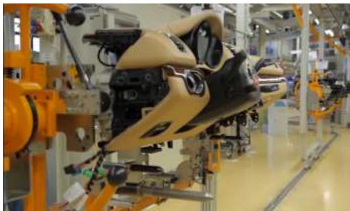
Figura 2.8 Movimentazione della plancia tramite un trasportatore automatico fisso ([www.porsche.com](http://www.porsche.com))
