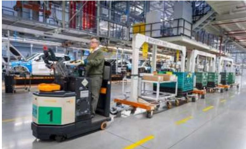
**Figura 2.6** Movimentazione del materiale all'interno della linea di assemblaggio tramite l'uso di un carrello trainante ([www.caranddriver.com](http://www.caranddriver.com)) [51]
