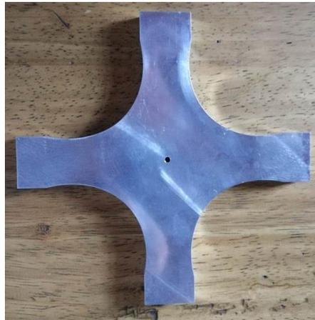
*Figura 56 Fotografia del provino in lega di alluminio 7075-T6*
