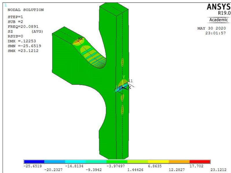
Figura 48 Andamento delle tensioni normali lungo l'asse z con un raggio di curvatura pari a 30 mm
