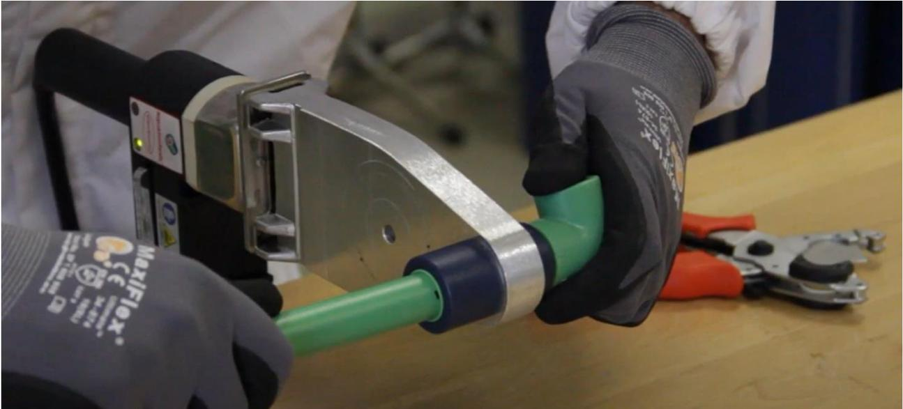
Figura 2.9 Giunzione tramite polifusione termica
