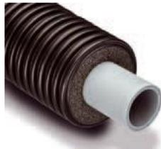
Figura 2.14 Tubazione in PB, isolante in poliolefine, protezione esterna con tubo corrugato in polietilene
