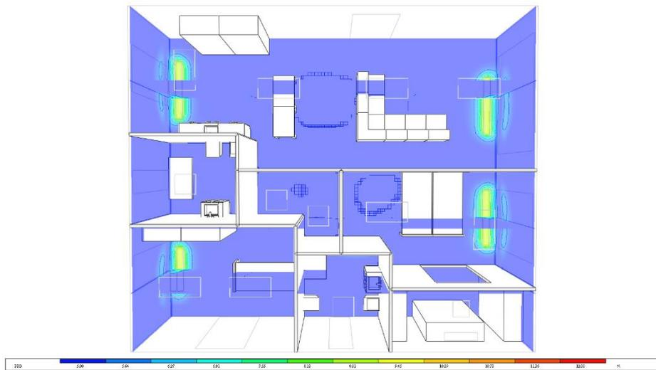
Figura 138- Ventilconvettori pavimento: Indici di comfort nell'alloggio 12a1 - caso con velocità dell'aria più elevata (2 m/s)
