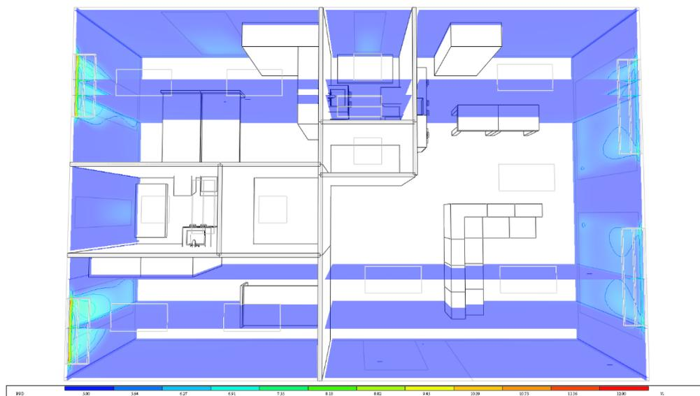
Figura 140- Ventilconvettori soffitto: Indici di comfort nell'alloggio 9a3
