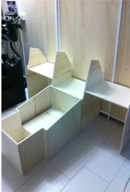
*Figura 21 Foto del primo assemblaggio delle lastre di pioppo per la realizzazione della cabina di pilotaggio.*
