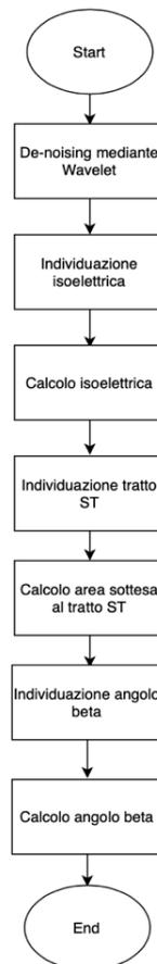
Figura 16. Flowchart descrivente la versione dell'algoritmo.
