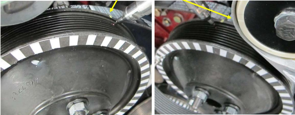
*Figura 3.6-La CMM misura un punto sulla puleggia 2 sul lato destro del tenditore (a sinistra)
