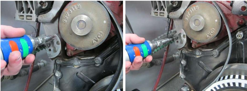
*Figura 3.8-La CMM misura un punto sulla superficie di montaggio del tenditore (a sinistra), e un punto del punto di pivot del tenditore (a destra)*
