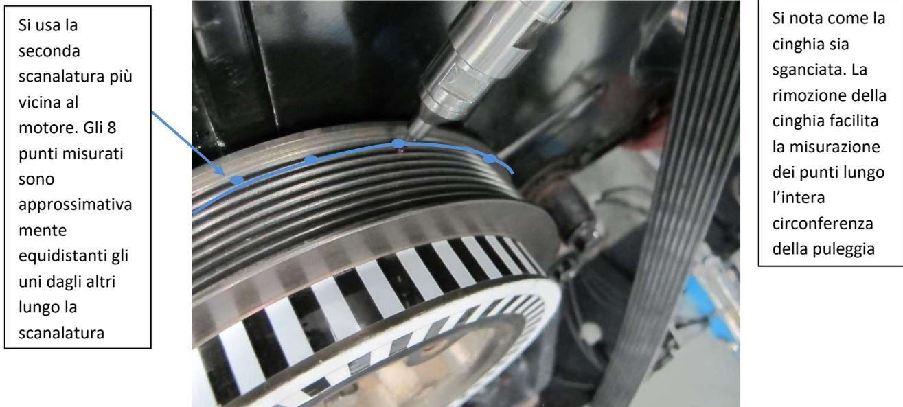
*Figura 3.5-Il braccio Faro misura un punto sul volano mediante il cristallo da 2.5mm*
