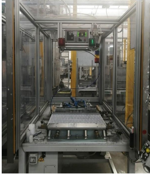
Figura 2.13 : esempio di banco manuale per il collaudo al delta p dei radiatori
