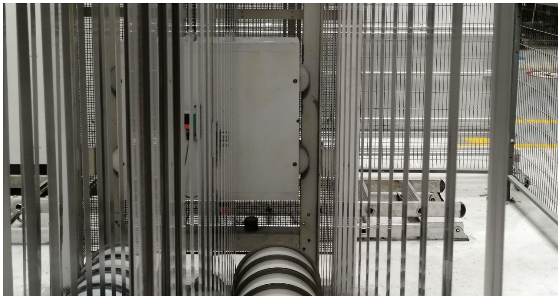
Figura 5.33 : contrappeso e fine corsa (nella parte inferiore) spostato verso il basso
