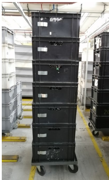
Figura 5.5 : impilamento di cassette su carrello (trolley)
