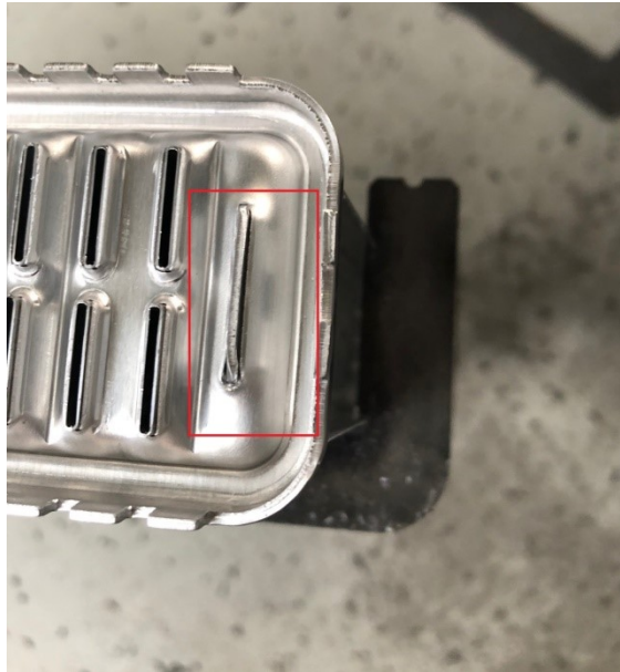
Figura 4.7 : errato inserimento del fianchetto
