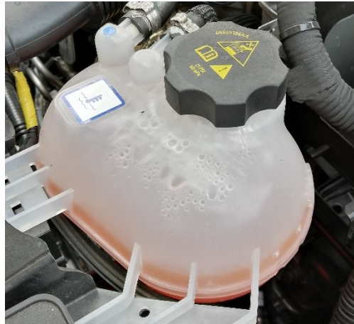
Figura 1.9 : esempio di serbatoio e tappo di sicurezza
