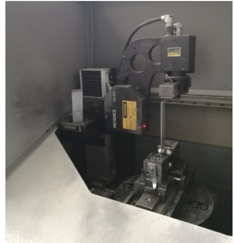
Figura 5.27 : banco di misura delle caratteristiche geometriche del tubo (a sinistra), con dettaglio del dispositivo di misura del profilo (a destra)
