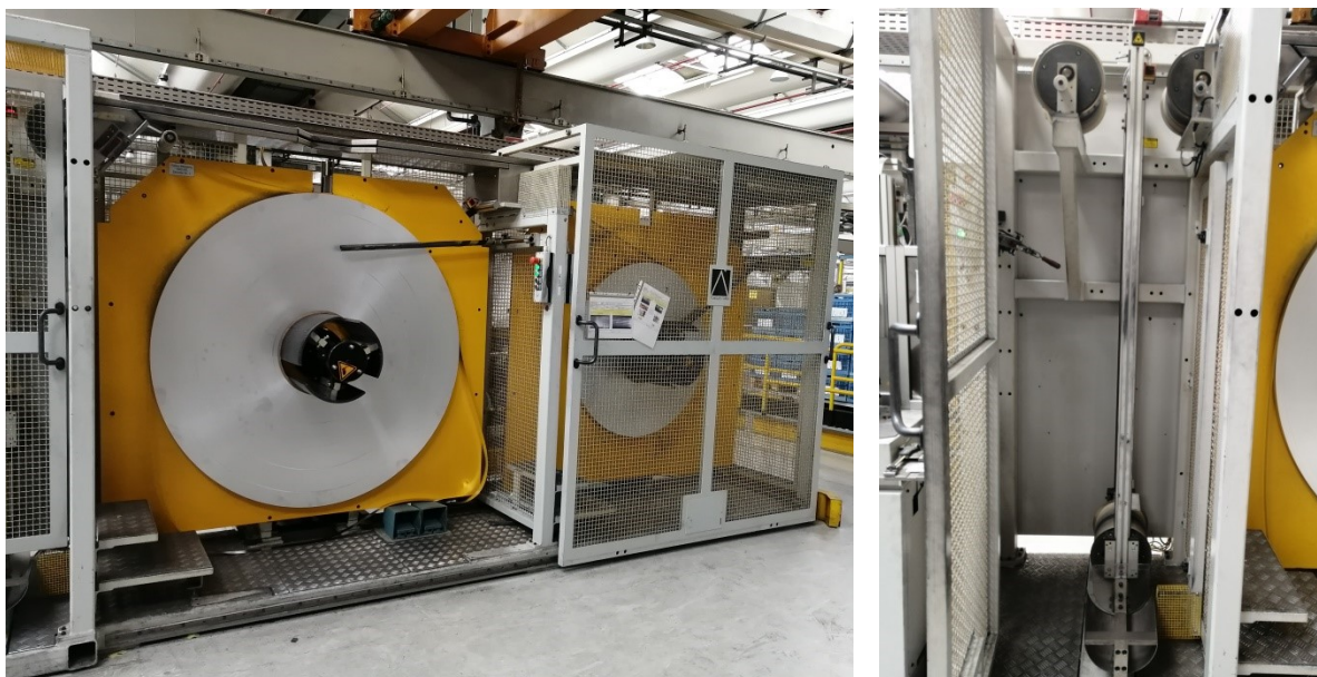
Figura 5.20 : gli aspi svolgitori della macchina (a sinistra) e il ballerino a fine corsa (a destra)
