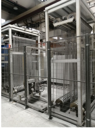
Figura 5.22 : gruppi di accumulo nastro
