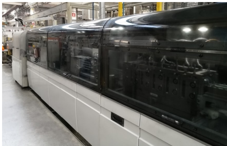
Figura 5.23 : gruppi di piegatura, saldatura, scordonatura e formatura (sull'estrema sinistra è possibile osservare anche la protezione del gruppo di taglio tubo)
