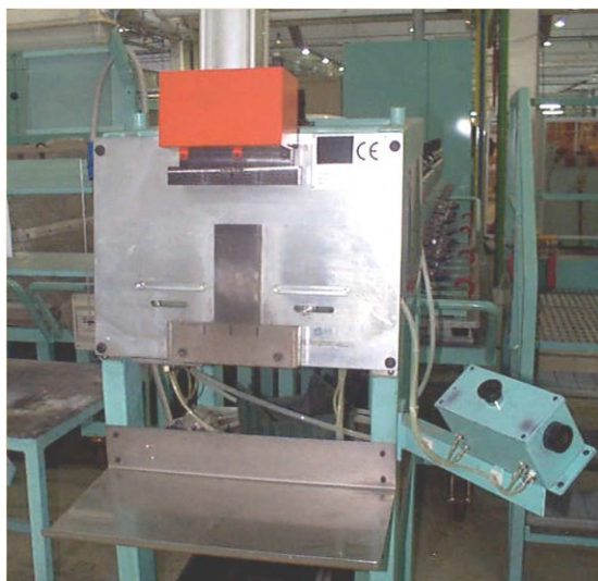
Figura 2.6 : macchina manuale a due stazioni (8)
