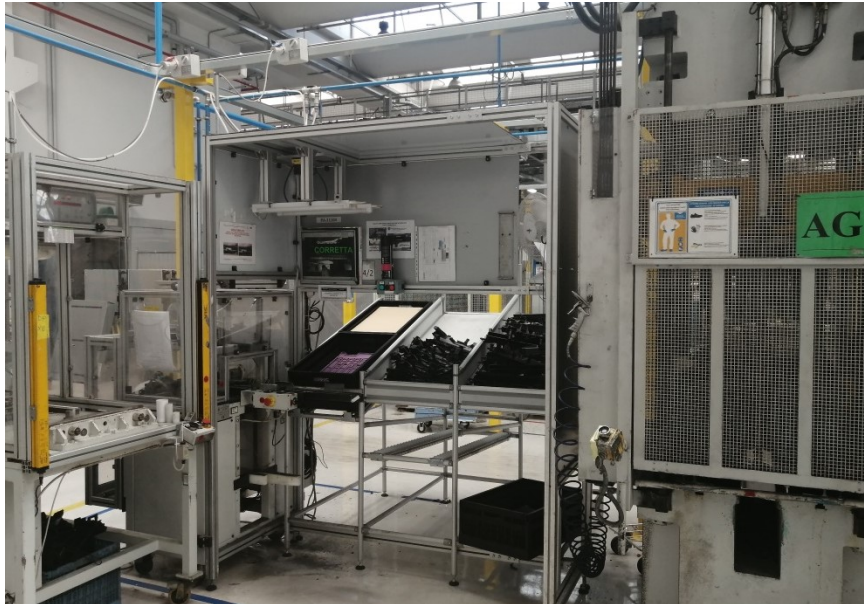
Figura 2.14 : esempio di postazione di collaudo e aggraffatura
