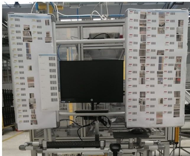
Figura 5.38 : postazione di rilevamento dello scarto in aggraffatura
