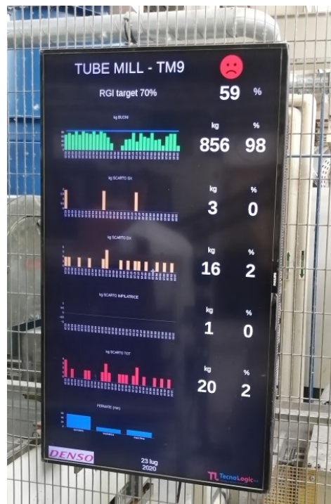
Figura 5.34 : schermo a bordo impianto per la visualizzazione dei dati in tempo reale
