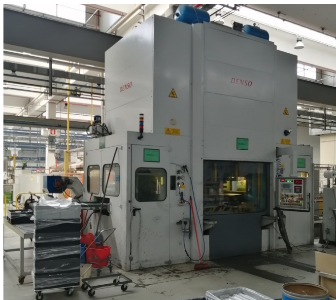
Figura 2.2 : pressa per lo stampaggio dei componenti in alluminio
