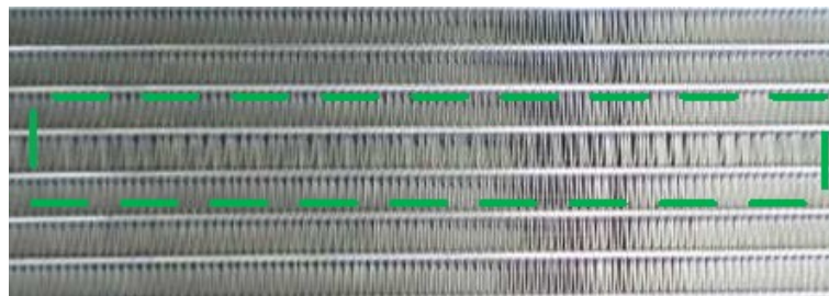
Figura 4.31 : blocco con una sola aletta a passo irregolare (accettabile)
