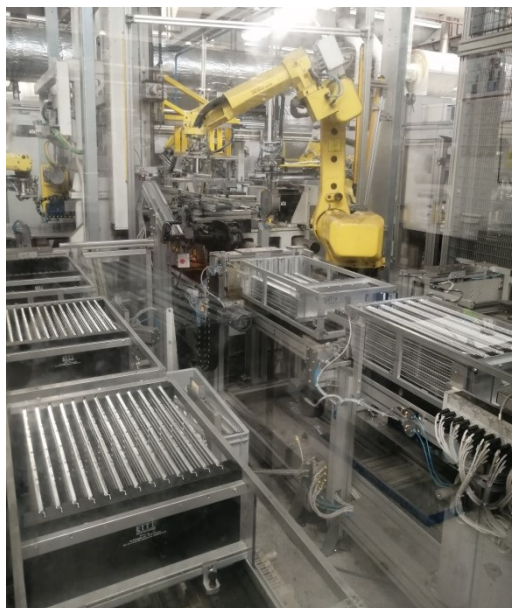
Figura 2.10 : dettaglio del carico automatico di collettori e fianchetti su impianto totalmente automatico
