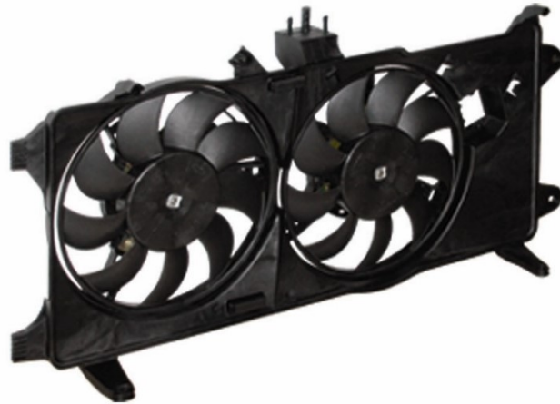
Figura 1.8 : ventola del sistema di raffreddamento motore in configurazione doppia
