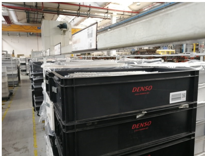
Figura 5.14 : particolare di uno dei fronti di deposito con traversa porta-cartellini e nuovo formato cartellino
