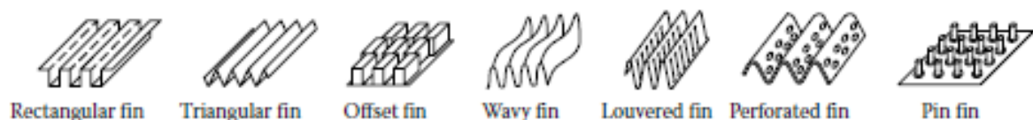
Figura 1.20 : tipologie di alette (5)
