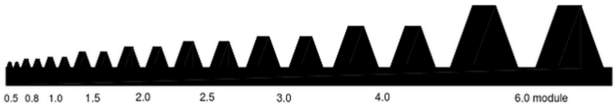
Figura 7 - Dimensione del dente in funzione al modulo
