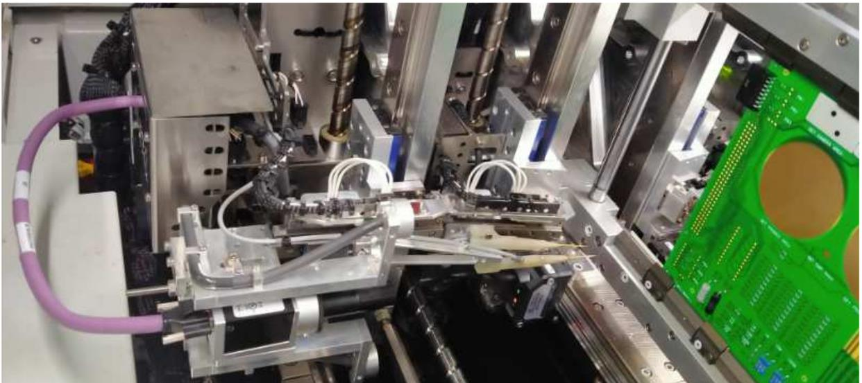
*Figura 20 - Allineamento della sonda 1 con il disco centrale della scheda OVP (inizio calibrazione)*
