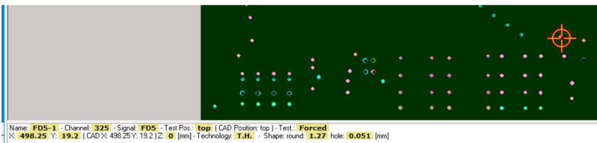
*Figura 49 - Coordinate CAD del fiducial 5*
