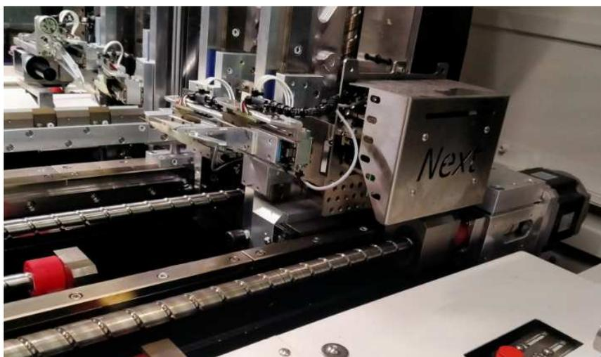
*Figura 2 - Azionamento asse x*
