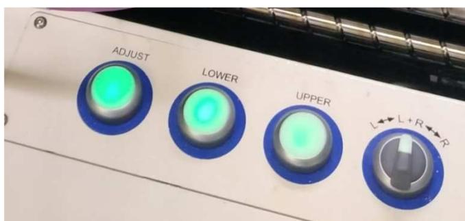
Figura 27 - Pulsanti per il fissaggio della scheda su V8 manuale
