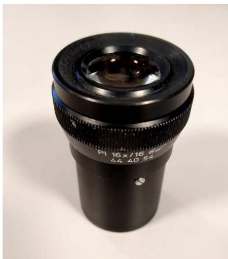
Figura 57 – Monocolo per l’osservazione delle impronte
