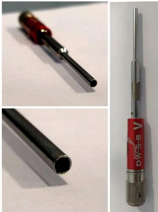
*Figura 25 - Strumento per avvitare e svitare le sonde*
