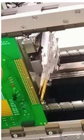
Il sondino capacitivo (*figura 13*) si distingue dalle altre sonde per la sua estremità piatta e per il fatto che il suo scopo è unicamente quello di effettuare misure di capacità su circuiti integrati. Applicando una piccola tensione sul chip per non danneggiarlo (tra la massa e un pin sulla scheda ad esempio), tramite la sonda capacitiva si può misurare la capacità del componente per determinate condizioni.
