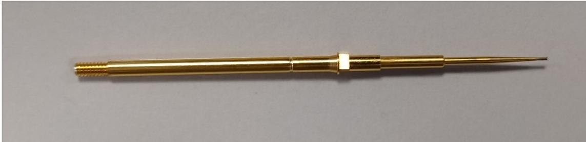
*Figura 10 - Sonda con punta a corona (Crown)*
