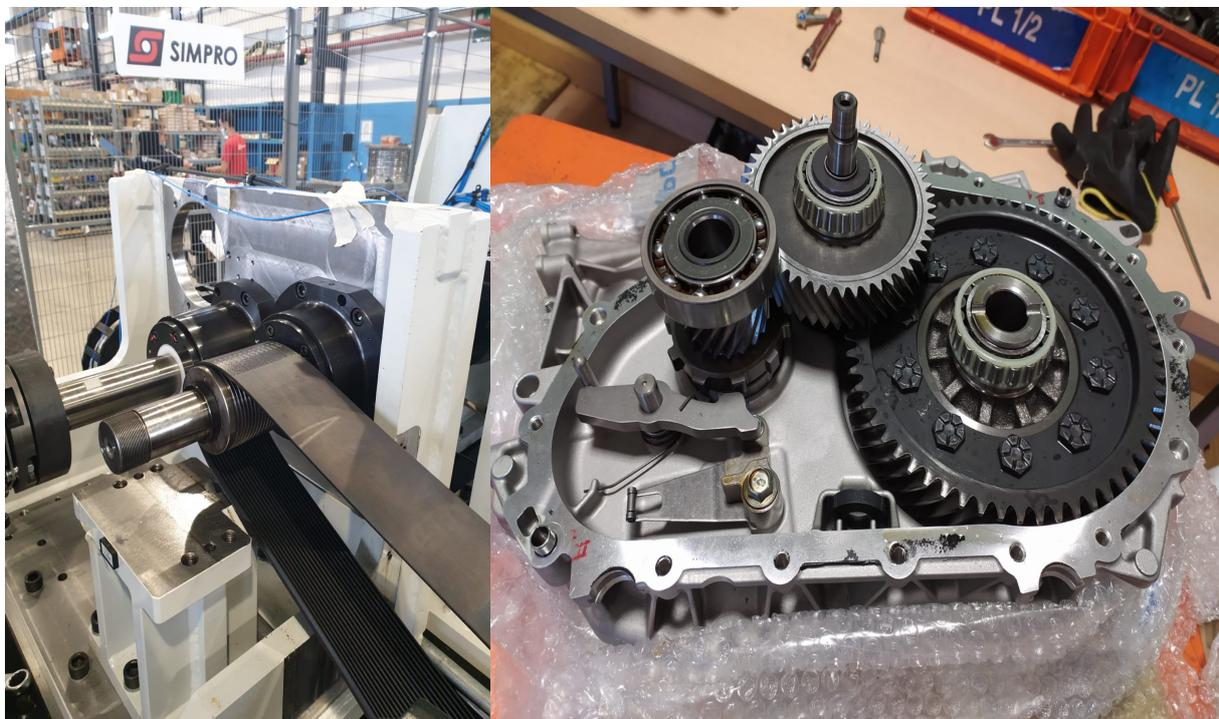
Figura 6.32: Smontaggio di cuscinetto e riduttore
