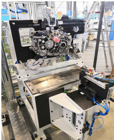
Figura 5.6: Isola di lubrificazione del riduttore
