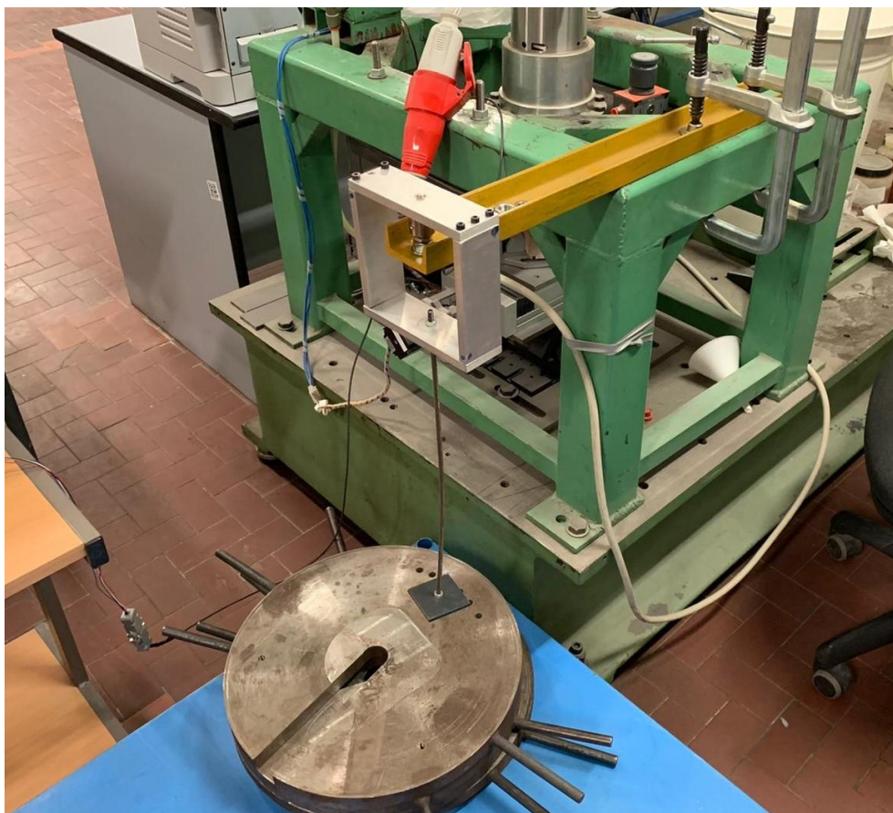
Figura 2.2.6: Prova di taratura della cella di carico con applicazione di masse da 20 kg l'una
