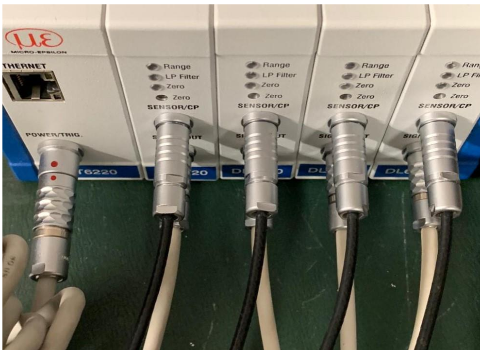
Figura A4: Sistema di condizionamento dei sensori capacitivi
