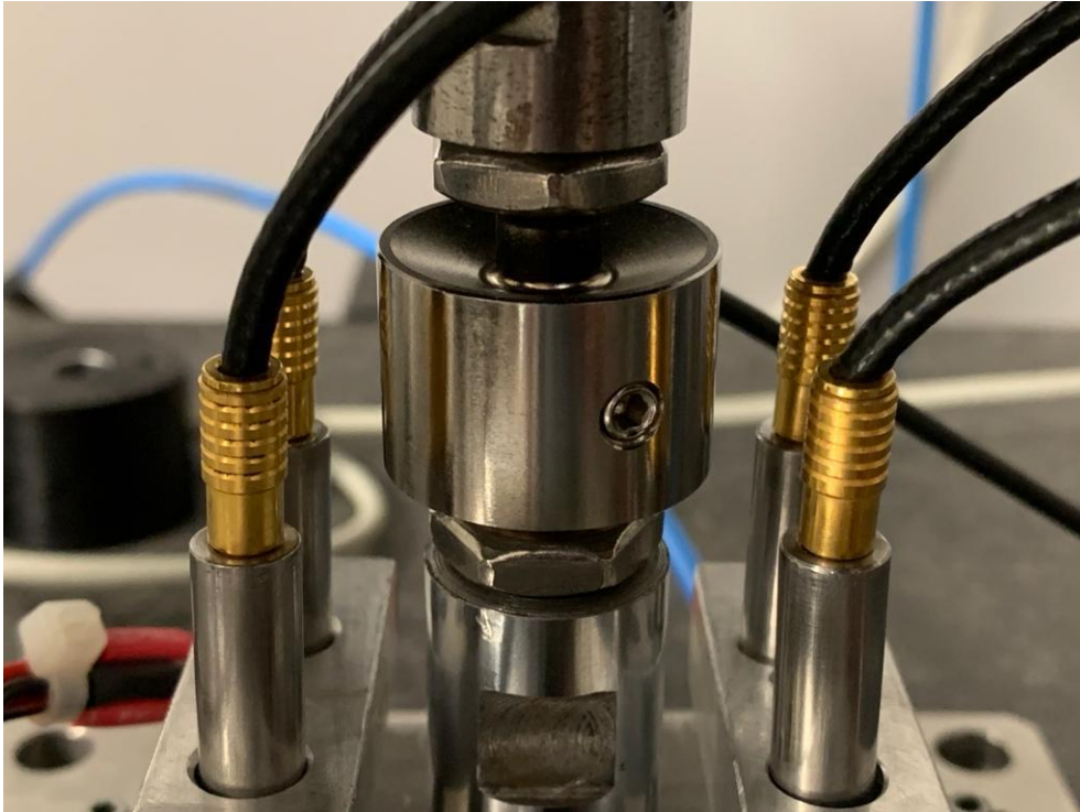
Figura A3: Sensori di posizione capacitivi collegati ai cavi diretti al sistema di condizionamento
