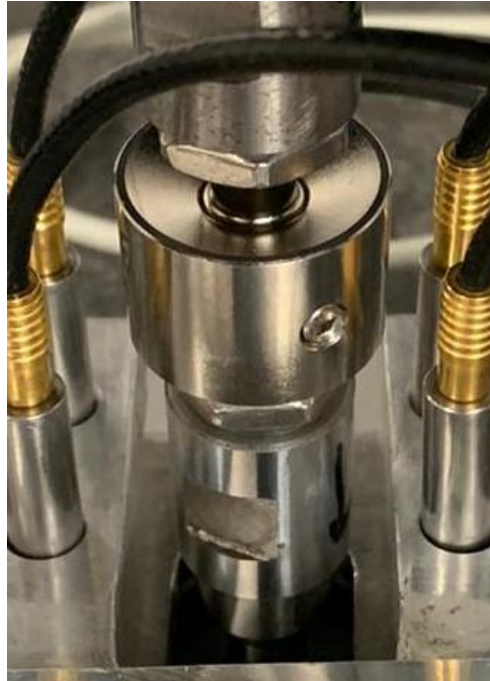
Figura A5: Cella di carico installata sulla pressa manuale
