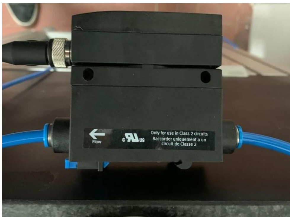
Figura A1: Collegamenti e posizione corretta del flussimetro digitale
