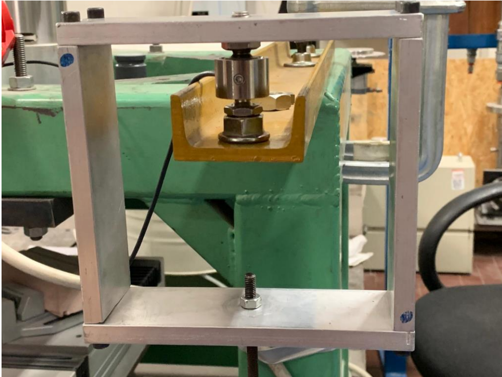
Figura 2.2.4: Cella di carico avvitata al porta-pesi
