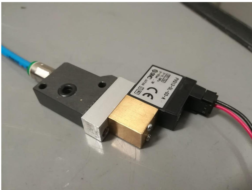
Figura 4.1.4: Valvola pneumatica dotata di blocchetti metallici di interfaccia per il montaggio al pattino
