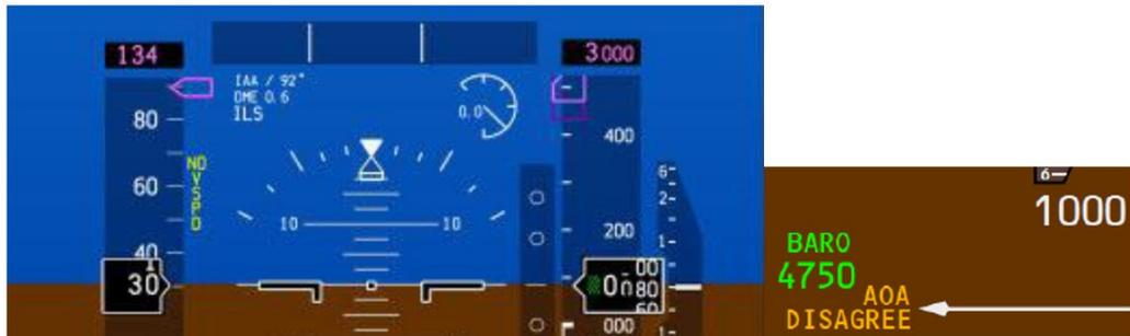
Figura 1.1: tipico messaggio di errore sul Boeing 737 Max
