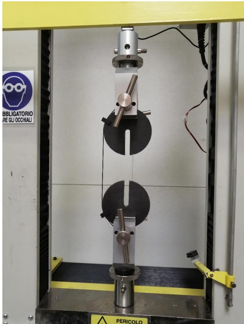
*Figura 22 Prima configurazione del test di trazione su filamento in PLA*
