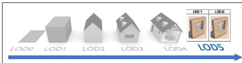
Figura 8 - Incremento dei LoD di CityGML.
