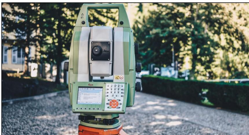
Figura 40 - Stazione totale Leica Nova Scan Station.
