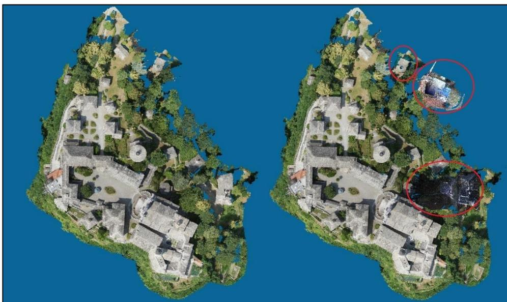
Figura 148 - Nuvola fotogrammetrica iniziale (sinistra) e nuvola fotogrammetrica con aggiunta di nuvole laser scanner opportunamente traslate (destra).
