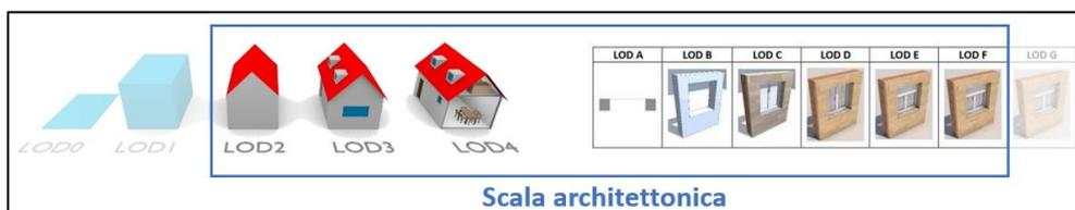
Figura 7 - Integrazione dei LoD di CityGML e i LOD dell'UNI11337-4:2017.
