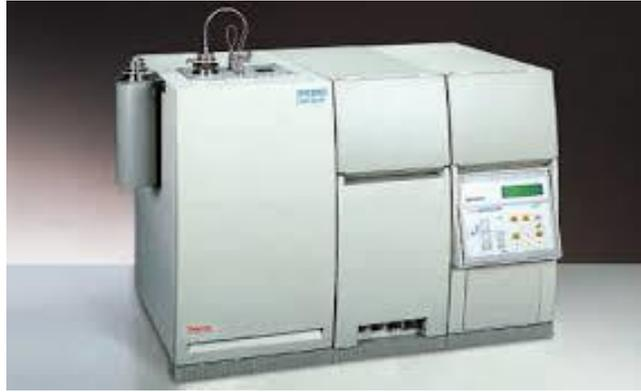
**Figura 4.3** Strumento utilizzato per le analisi H<sub>2</sub>-TPR e O<sub>2</sub>-TPD[23]
