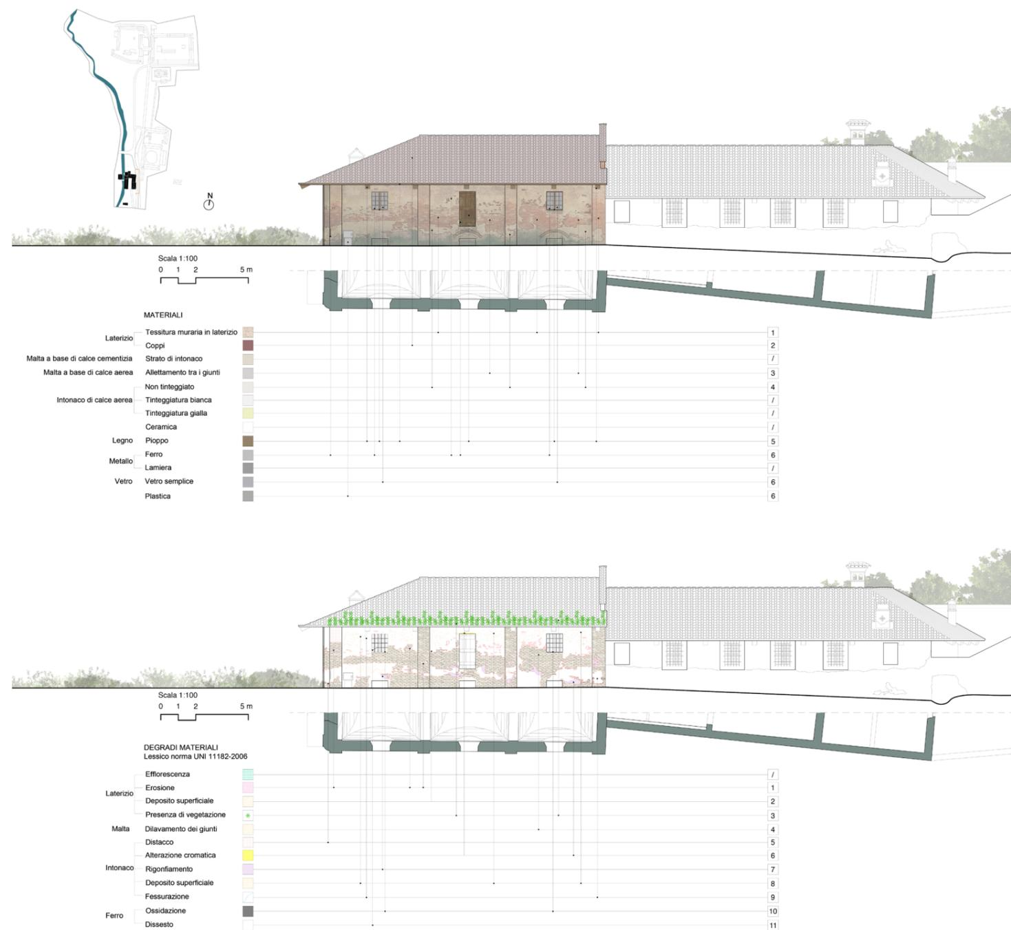
Figura 96: Analisi materica (sopra) e analisi dei degradi (sotto) del prospetto est manica est, fronte strada, elaborazione personale
