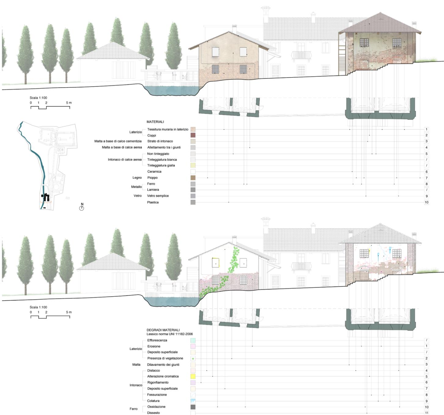
Figura 97: Analisi materica (sopra) e analisi dei degradi (sotto) del prospetto sud, elaborazione personale
