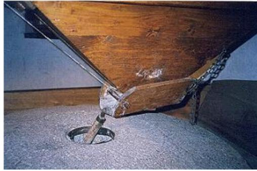
Figura 11: Particolare della "tafferia", elemento attraverso cui viene fatto cadere il frumento da macinare e del paletto di legno che ne regola la caduta
