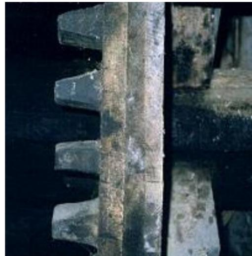
Figura 4: Particolare dei denti di legno della "ruota dentata" del mulino comunale lungo il torrente Piova a Pelos di Cadore
