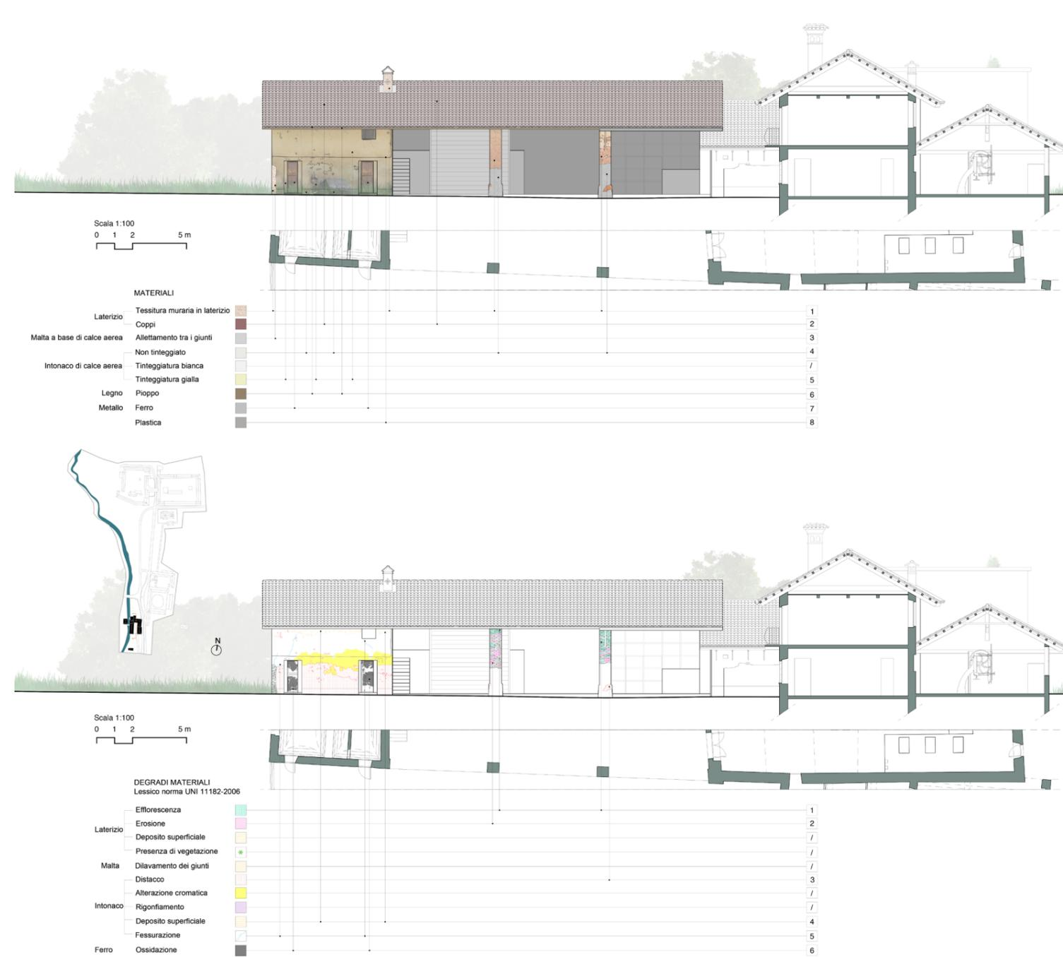
Figura 98: Analisi materica (sopra) e analisi dei degradi (sotto) del prospetto est manica ovest, corte interna, elaborazione personale
