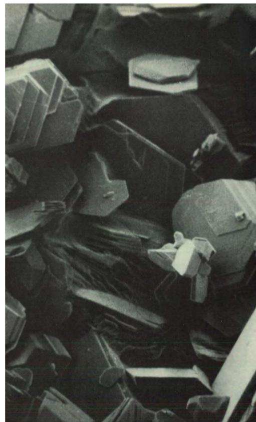
Figura 13: Microfotografia di un minerale di argilla ingrandita 15000 volte, si tratta della dickite, una varietà di caolino, che si presenta in lamelle esagonali ben formate, ciascuna delle quali è costituita da strati fogliettati. Foto di: Keller, W. D., Università del Missouri, Colombia
