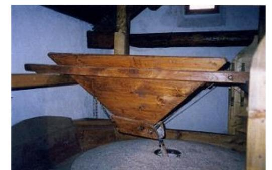
Figura 10: Particolare della tramoggia posta al di sopra del palmento mobile all'interno del mulino
