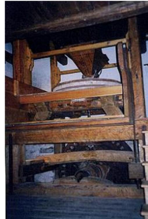
Figura 8: Particolare di una temperatoia, sistema a leva attraverso il quale si modifica la posizione dell'ingranaggio a lanterna e di conseguenza quella del palmento superiore, alzandolo od abbassandolo
