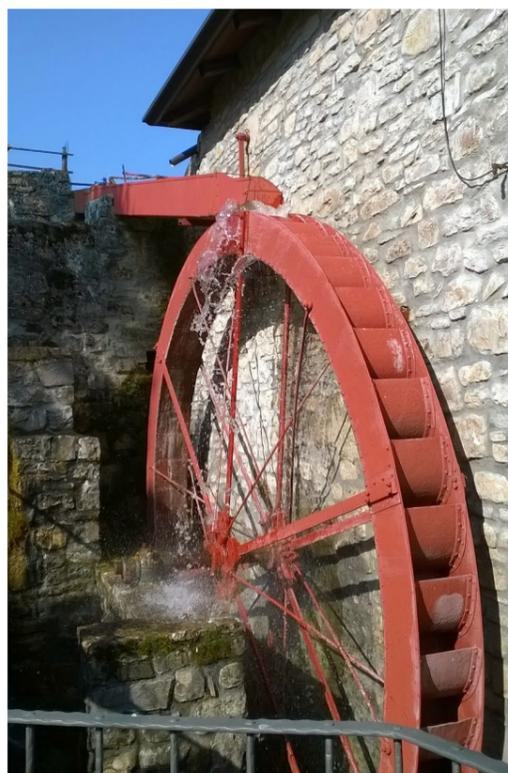
Figura 23: Dettaglio della ruota metallica del mulino Pellegro, a cassette e ad alimentazione superiore, 2010
