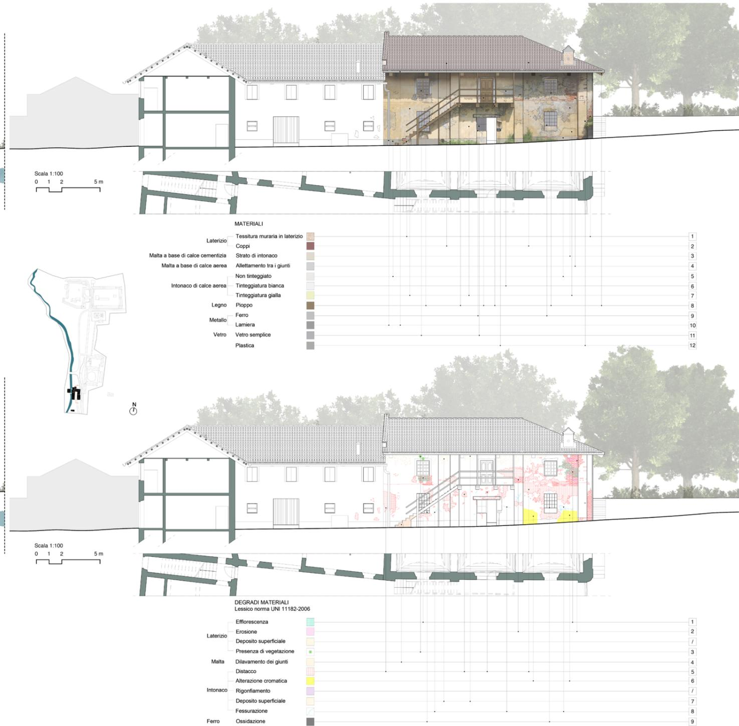
Figura 100: Analisi materica (sopra) e analisi dei degradi (sotto) del prospetto ovest manica est, corte interna, elaborazione personale
