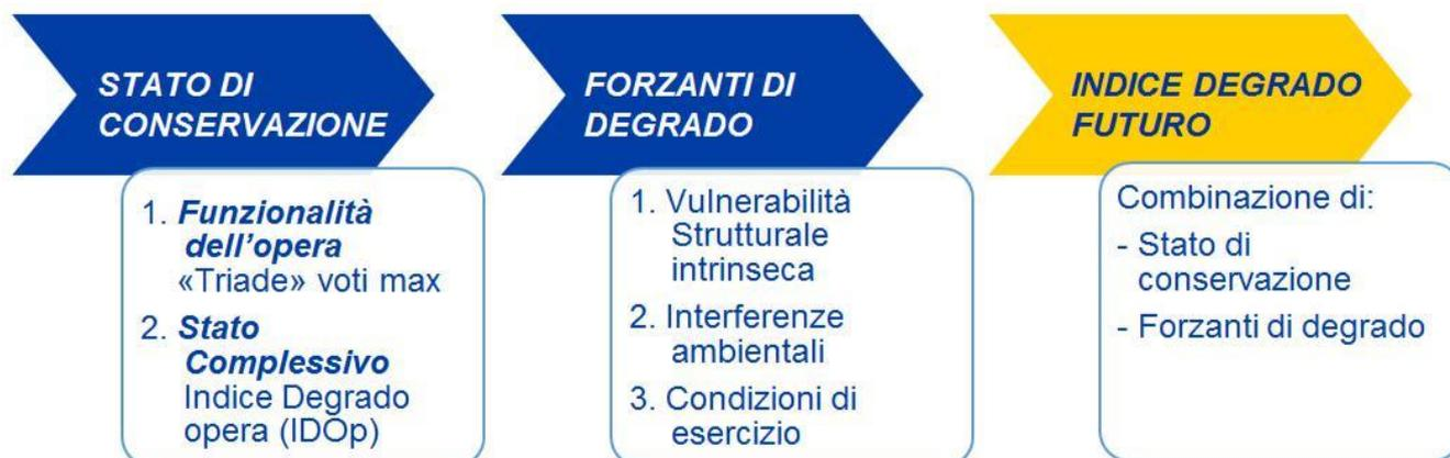
La **Funzionalità dell'opera** rappresenta la capacità dell'opera di garantire il servizio con continuità e sicurezza in base ai singoli difetti rilevati.
