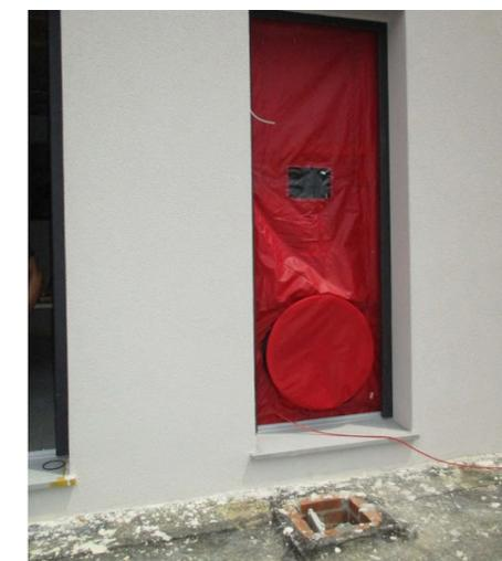
Figura 5, sistema Blower-door test (interno ed esterno del fabbricato)
