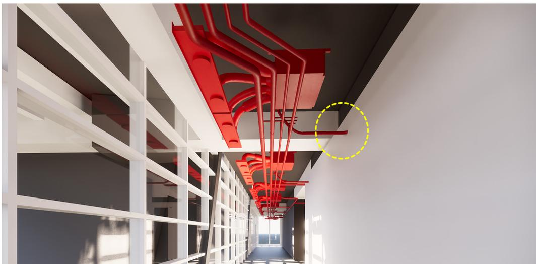
Figura 94: interferenza MEP - architettonico
