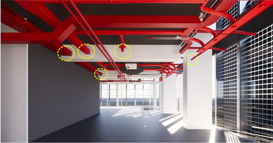
Figura 95: interferenza MEP - strutturale
