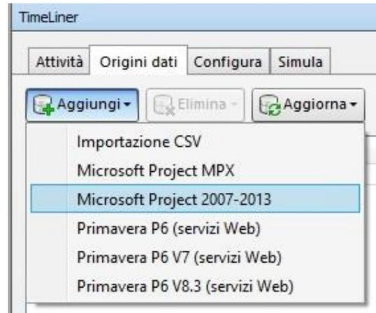
Figura 85-La finestra Origini Dati che serve per importare i file Project all'interno di Navisworks 2020
