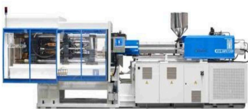
Figura 3. Pressa ad iniezione BMB di media dimensione
