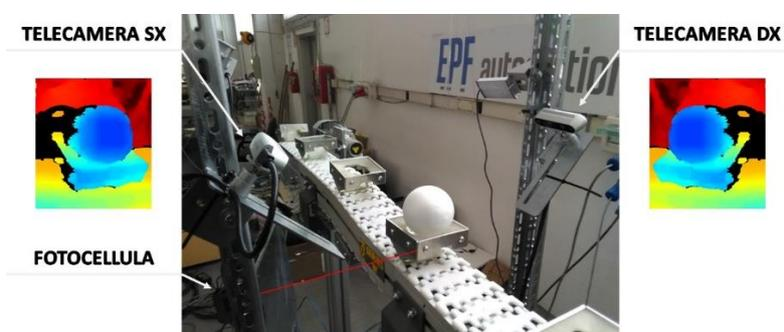
**Figura 5.47: Cattura delle immagini 3D sul nastro trasportatore**
