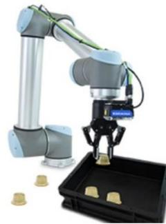
**Figura 4.19: Esempi di robot per pick and place 2D [37] [38]**
