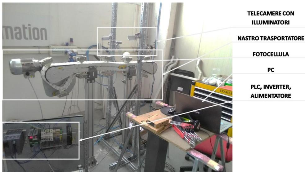
**Figura 5.14: Vista complessiva del prototipo del sistema**
