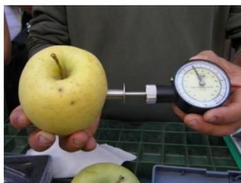
**Figura 1.7: Penetrometro a puntale per la misurazione della durezza [6]**
