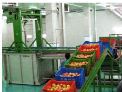
**Figura 2.2: Nastri trasportatori per il trasporto delle casse [17]**
