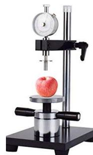
**Figura 1.9: Penetrometro da banco per la misurazione della durezza [7]**
