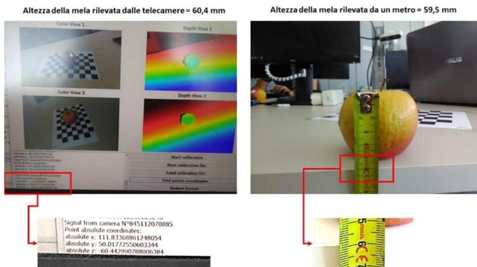
Figura 6.1: Precisione delle telecamere dopo la correzione del bug
