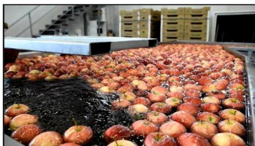
**Figura 2.3: Svuotamento delle casse per immersione [18]**
