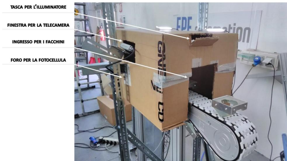
**Figura 5.18: Isolamento della zona della cattura delle immagini 3D**
