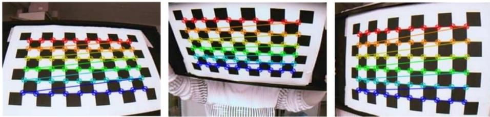
Figura 4.26: Riconoscimento della scacchiera di calibrazione da diverse angolazioni [42]
