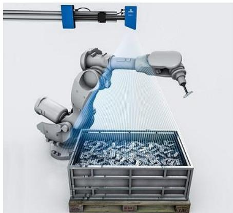
Figura 4.18: robot per bin picking e sistema di visione [36]
