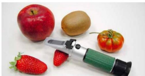
**Figura 1.6: Rifrattometro per la misurazione del grado zuccherino [5]**
