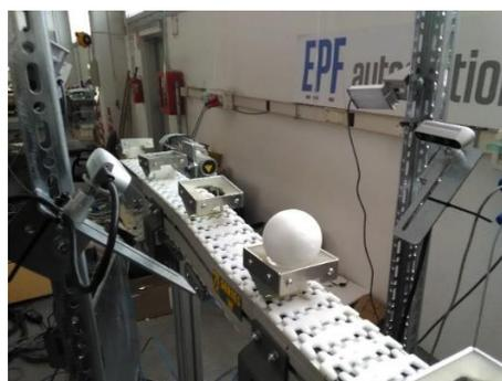
**Figura 5.16: Test della cattura di immagini 3D**
