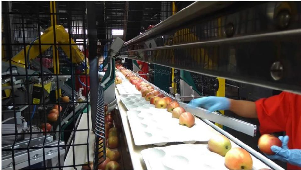
**Figura 3.6: Picking effettuato da robot ed operatori umani [22]**
