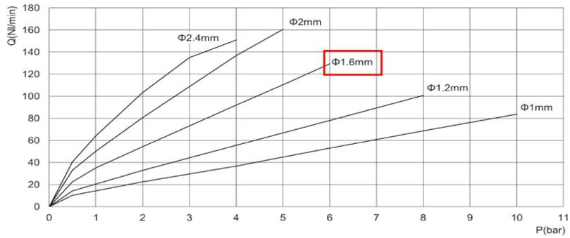
Figura 2-6: portata massima valvola in funzione pressione taratura
