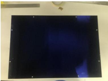
a. **Copertura trasparente:** pannello in PMMA di dimensioni 59.5x42x0.25 cm.
