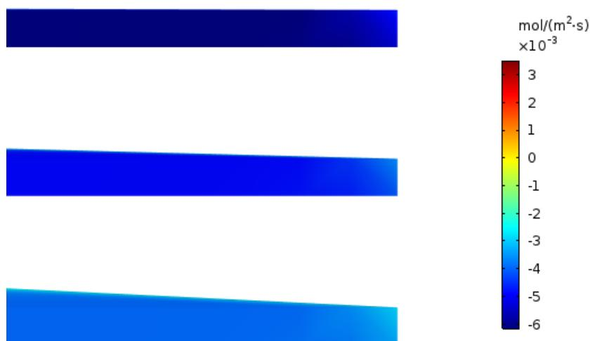
Figura 2. 9 - Flusso di vapore acqueo al bordo d'uscita delle tre membrane idrofobe. 'Immagine presa da [65]'
