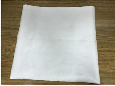
e. **Membrane idrofobiche:** x3 membrane composte in PTFE (polytetrafluorethylene), di dimensioni 63x52 cm, grandezza dei pori compresa tra 0.1  $\mu\text{m}$  e 0.3  $\mu\text{m}$ .
