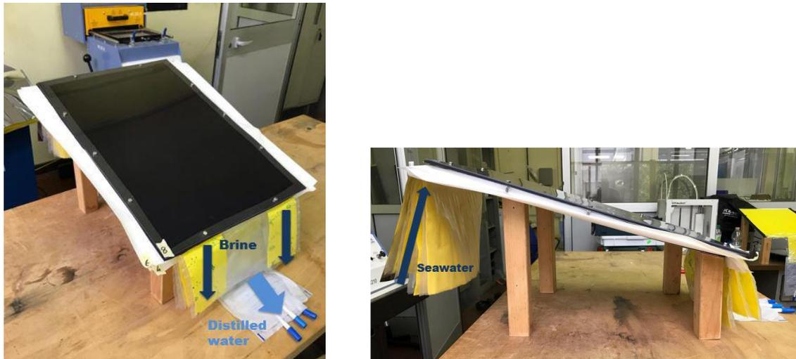
*Figura 3. 12 - Dissalatore completamente assemblato nelle viste isometrica (sx) e laterale (dx)*
