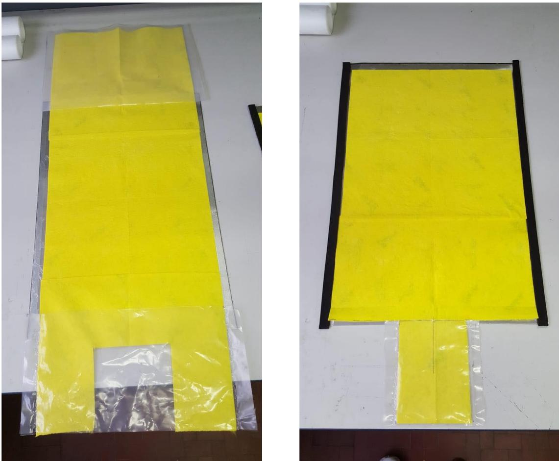
*Figura 3. 9 - Evaporatore (sinistra); Condensatore (destra)*
