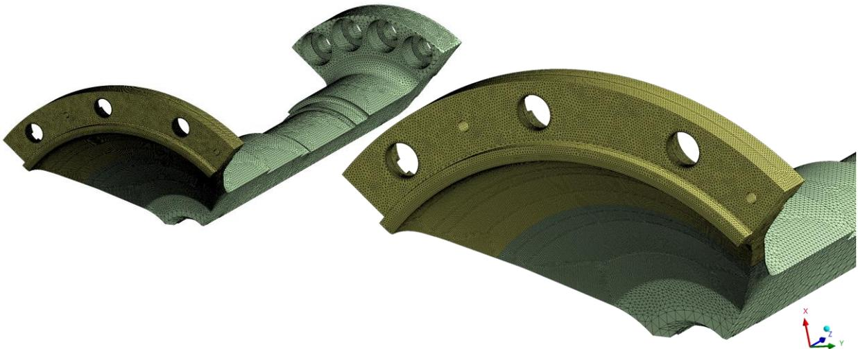
Figura 3.84 -- Mesh generata su FWD stubshaft
