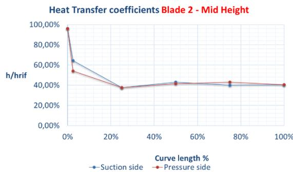
Figura 3.11– HTC a metà altezza della pala rotorica del secondo stadio.
