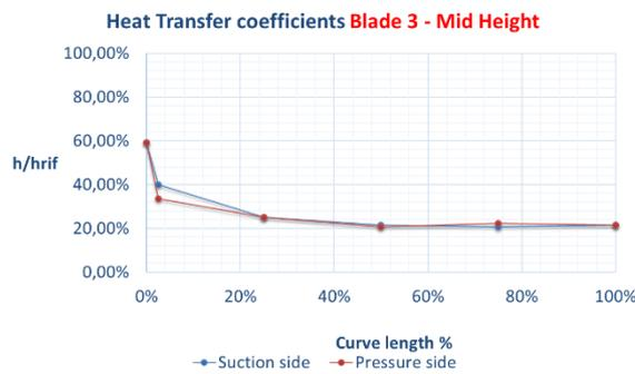
Figura 3.13 – HTC al raggio este a metà altezza della pala rotorica del terzo stadio.
