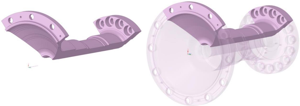
Figura 3.82 – Settore analizzato *afterward stubshaft*.
