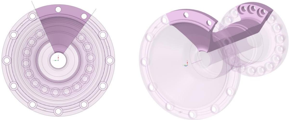
Figura 3.74 – Settore analizzato del *forward stubshaft*.
