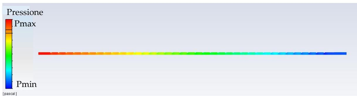
Figura 3.22 – Andamento della pressione nel canale di raffreddamento
