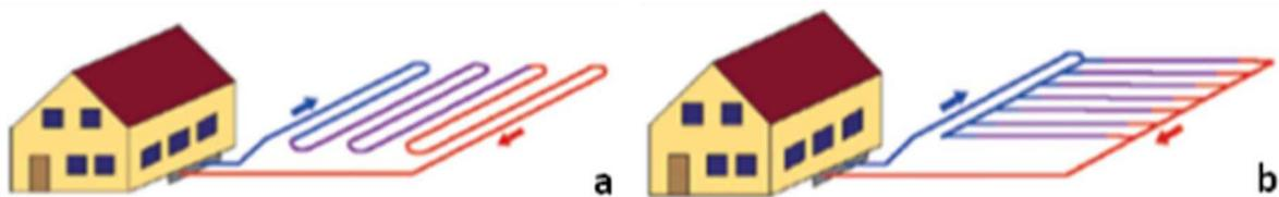
Figura 2.15. Sonde geotermiche orizzontali in serie (a) e in parallelo (b) (Karytsas, 2017)
