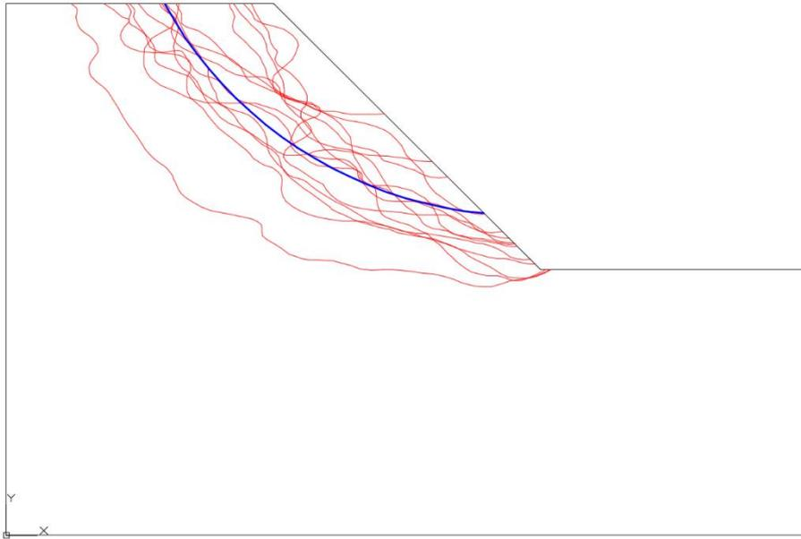
*Figura 57. Andamento di tutte le superfici di scivolamento per i modelli 0\_70\_ZZ (linee rosse), confrontate con quella del modello di sola matrice (linea blu)*
